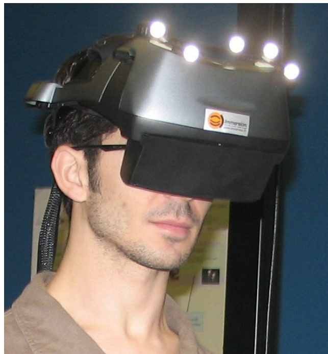
FIGURE 1.29 – Visio-casque avec accusation optique de la position de la tête.
