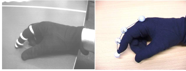
FIGURE 1.50 – Gants avec marqueurs retro-réfléchissants [Dorf Müller-Ulhaas et Schmalstieg, 2001].
