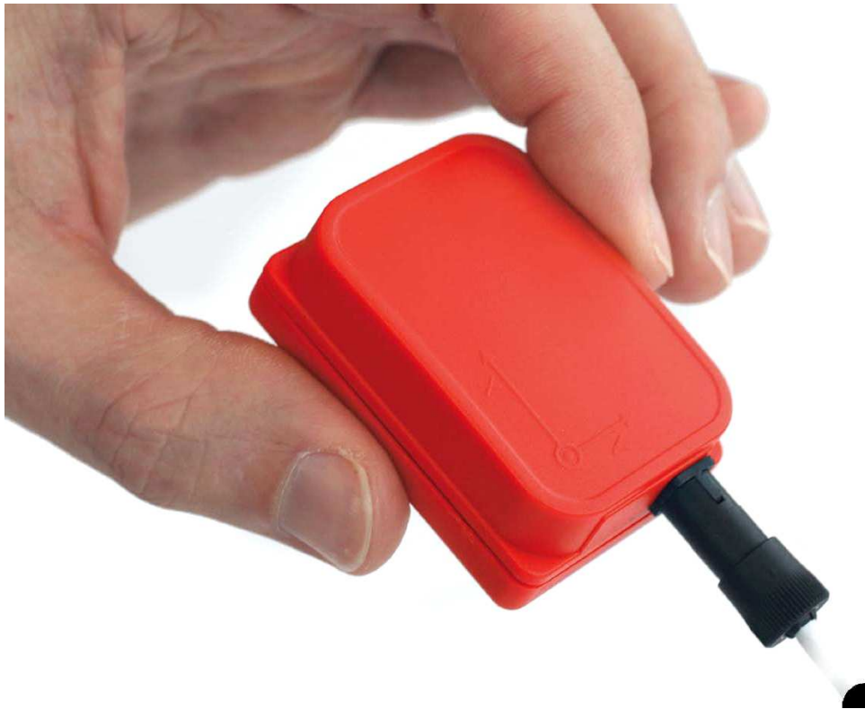
FIGURE 1.24 – La centrale inertielle MTx de Xsens .
