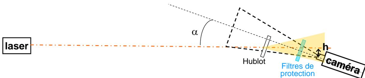
Figure 105 : Dispositif expérimental des expériences d'éblouissement de capteurs.
