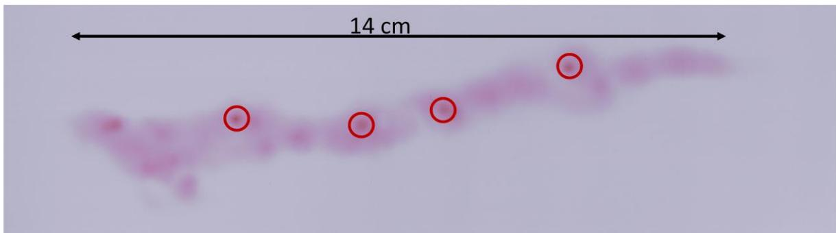
Figure 96 : Impact sur papier photographique obtenu à 1 km montrant la proportion de plasma (cercle rouge) vis-à-vis de l'ensemble du faisceau laser.
