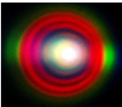
Figure 93 : Photographie du faisceau multicolore obtenu en laboratoire en focalisant une impulsion de 50  $\mu$ J dans un cristal de  $\text{CaF}_2$ . Les anneaux colorés observés sont appelés émission conique (diamètre 10 cm).
