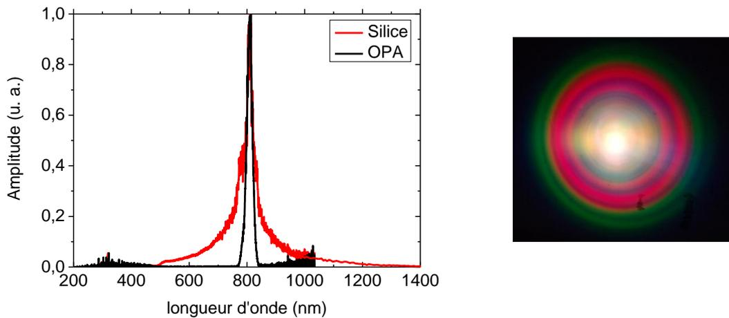
Figure 56 : A gauche : Spectres obtenus avant et après filamentation dans un cristal de silice de  $1 \text{ cm}$  d'épaisseur. A droite : photographie du continuum de lumière blanche (au centre) et de l'émission conique (cercles colorés) générés dans le même échantillon.
