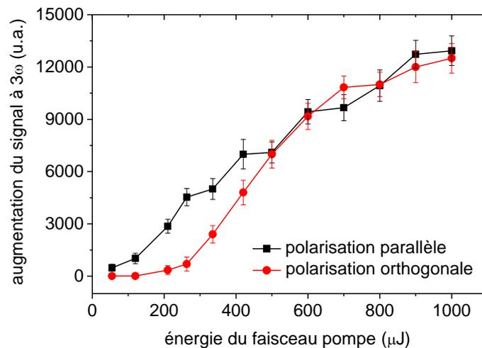
Figure 36 : Augmentation de la troisième harmonique générée en fonction de l'énergie du faisceau pompe. L'énergie du filament signal est fixée à  $330 \mu\text{J}$ . Les conditions expérimentales sont les mêmes que pour la figure précédente.
