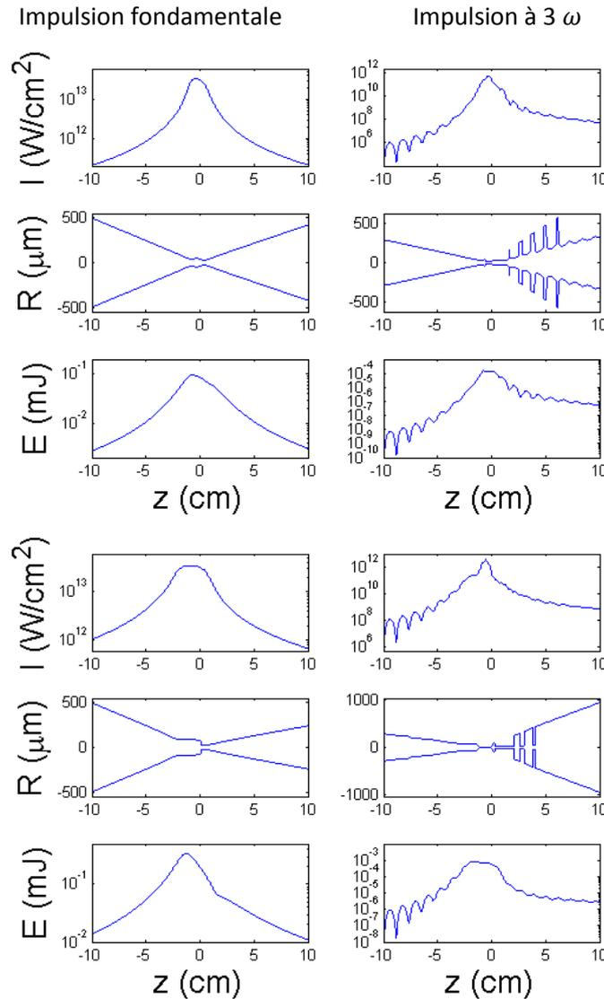
**Figure 41 :** Dynamique de propagation de l'impulsion fondamentale (première colonne) et de la troisième harmonique (seconde colonne) dans les conditions expérimentales décrites dans le texte. Les mêmes quantités que dans la Figure 40 sont représentées, cependant l'échelle logarithmique est utilisée dans la première et troisième ligne afin d'accentuer le fait que l'énergie contenue dans la troisième harmonique n'est pas entièrement restituée à la fin du filament.
