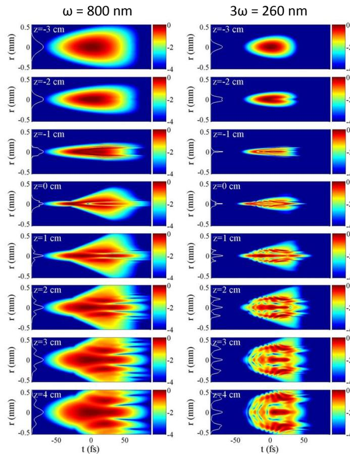
Figure 42 : Evolution spatio-temporelle (intensité en fonction des dimensions  $r$  coordonnée radiale et  $t$  temps) de l’impulsion fondamentale (première colonne) et de sa troisième harmonique (deuxième colonne) en fonction de la distance de propagation  $z$  pour une énergie incidente de 500  $\mu\text{J}$ . Le waist devrait être de 30  $\mu\text{m}$  si la propagation avait été linéaire. Les courbes blanches intégrées sur la gauche de chaque figure représentent les profils de fluence.
