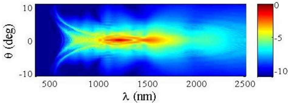
Figure 70 : Résultat de simulation numérique représentant la répartition angulaire  $\theta$  des longueurs d'onde  $\lambda$  générées au cours de la filamentation laser dans la silice pour  $\lambda_0 = 1,2 \mu\text{m}$ .
