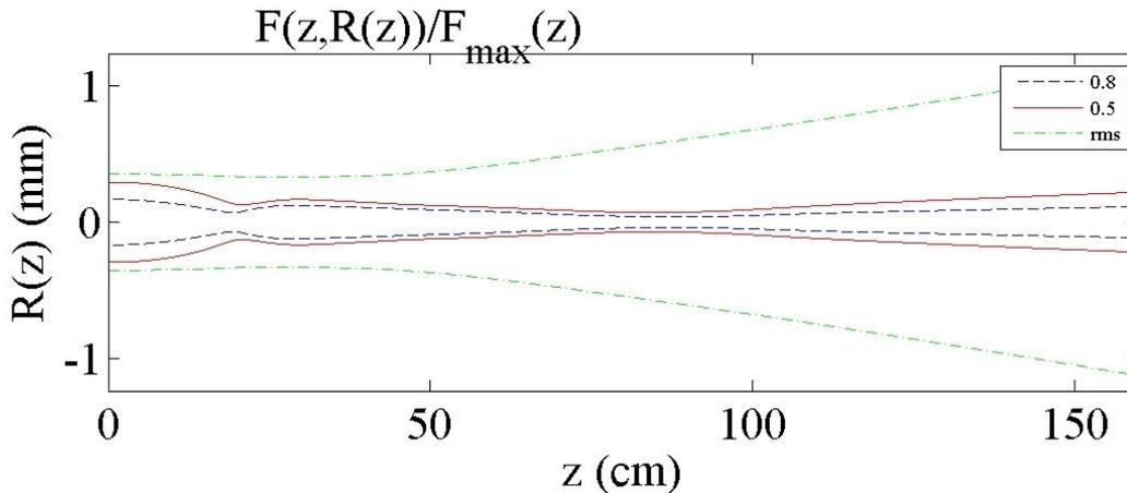
Figure 3 : Résultat de simulation pour une impulsion de 1 mJ, 50 fs, non-focalisée se propageant dans l'air et dont la largeur à mi-hauteur initiale est de 0,5 cm.
