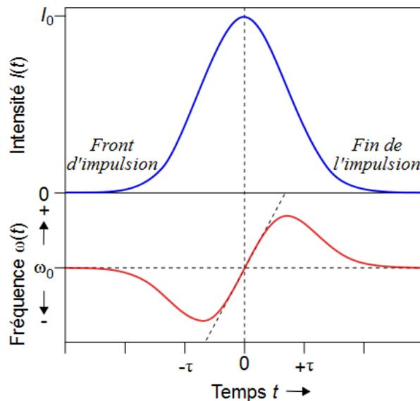
Figure 4 : Phénomène d'auto-modulation de phase. En haut, profil d'intensité d'une impulsion gaussienne. En bas, fréquence instantanée de l'impulsion autour de sa fréquence centrale  $\nu_0$ . La tangente à l'origine est appelée chirp. Si elle est à pente positive (négative), on parle de chirp positif (négatif).
