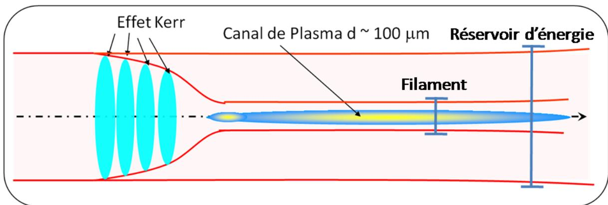
Figure 2 : Schéma de principe de la filamentation laser.
