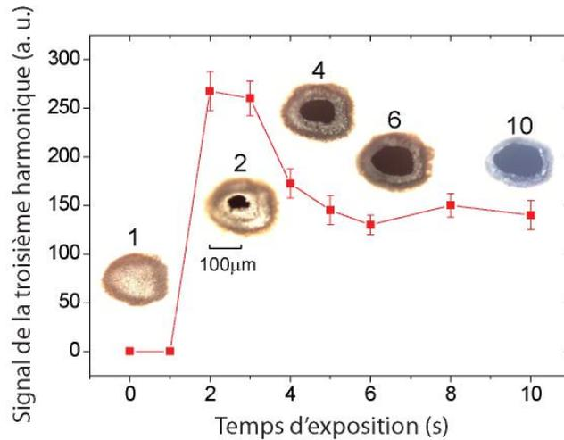
**Figure 38 :** Troisième harmonique générée après l'insertion d'une feuille d'aluminium de 150 µm d'épaisseur dans le centre d'un filament signal de 4 cm. En insert sont présentés des photographies de la feuille d'aluminium après exposition au filament, le nombre sur le dessus indique le temps d'exposition en secondes sachant que la cadence du laser est de 100 Hz.
