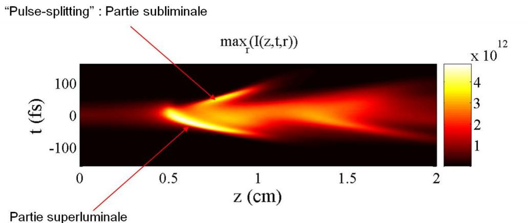
Figure 63 : Résultat de simulation représentant l'évolution selon l'axe de propagation  $z$  de la forme temporelle d'une impulsion à 800 nm ( $4 \mu\text{J}$ , 50 fs) au cours de sa propagation sous forme de filament dans de la silice.  $t$  est le temps dans le référentiel de l'impulsion. Mise en évidence du phénomène de « pulse-splitting ».
