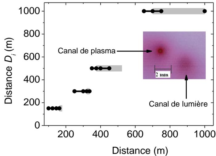
Figure 90 : Mesure de la position des canaux de plasma (point noir) et la position des canaux de lumière (ligne grise) pour différentes distances  $D_i$ . En insert : exemple d'impact sur papier photographique montrant la présence de canaux de plasma et de canaux de lumière à une distance de 700 m.
