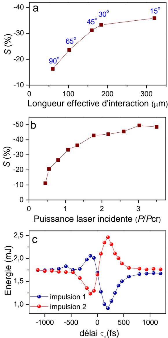
Figure 29 : Efficacité d'échange d'énergie en fonction des paramètres expérimentaux. (a)  $S$  en fonction de la longueur d'interaction  $L$ . Pour  $P = 1, 15 P_{cr}$  et  $f = 30$  cm. (b)  $S$  en fonction de la puissance laser incidente avec  $\varphi = 20^\circ$  et  $f = 12,5$  cm. (c) Echange d'énergie dans les conditions (b) avec  $P = 1,5 P_{cr}$ .
