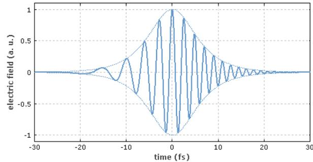
**Figure 7 : Champ électrique d'une impulsion chirpée. La fréquence d'oscillation du champ électrique de l'impulsion chirpée varie avec le temps. Ici, l'impulsion est chirpée positivement. ([www.rp-photonics.com](http://www.rp-photonics.com))**
