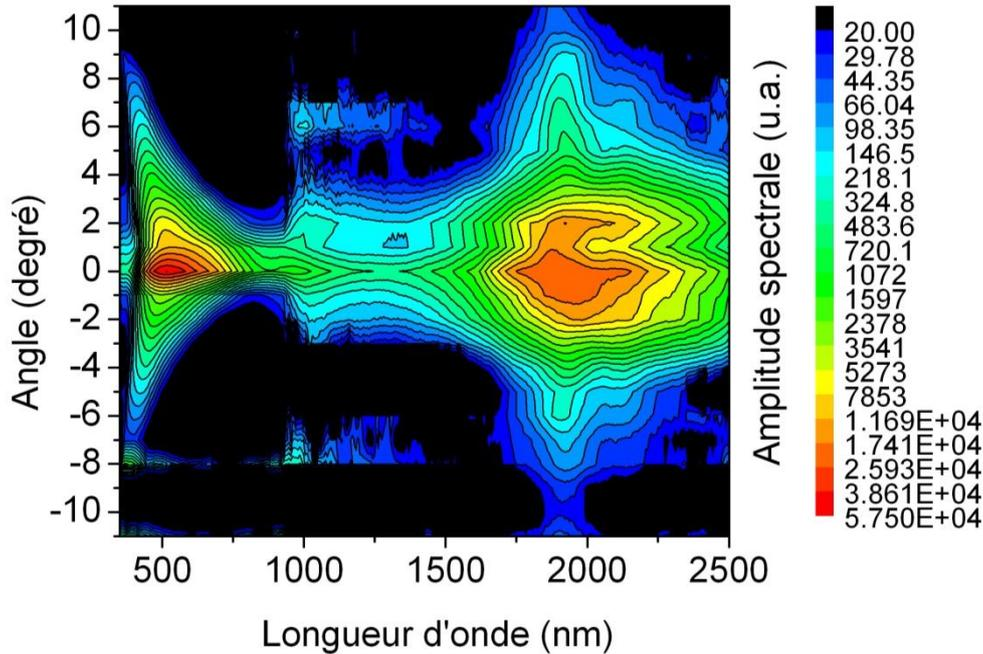
Figure 74 : Répartition spectrale de l'énergie en fonction de l'angle  $\theta$  pour  $\lambda_0 = 1,9 \mu\text{m}$  dans la silice pour une énergie laser incidente de  $E = 15 \mu\text{J}$ . Les niveaux de couleurs représentent l'amplitude des différentes longueurs d'onde.
