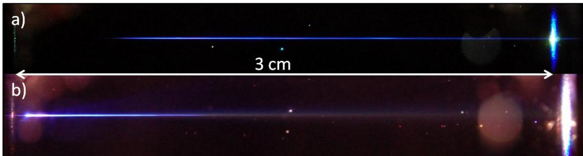
Figure 77 : Photographie d'un filament dans un cube de silice fondue de 3 cm d'épaisseur pour une impulsion de 15 μJ, 50 fs a) pour  $\lambda_0 = 1,9 \mu\text{m}$ , b) pour  $\lambda_0 = 0,8 \mu\text{m}$ .
