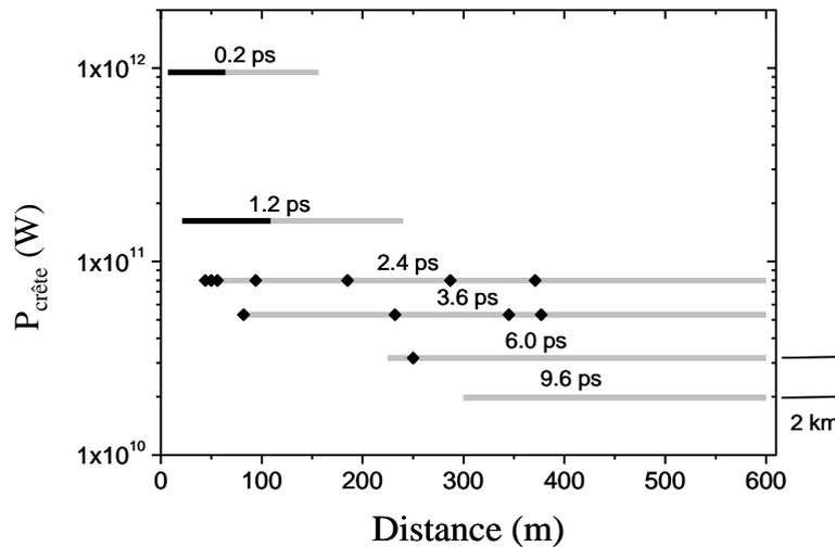
**Figure 80 : Evolution de la longueur de filamentation en fonction de la distance de propagation en variant le chirp initial de l'impulsion laser. L'impulsion non chirpée a une durée minimum de 100 fs. Les lignes noires et les points noirs rendent compte de la présence d'ionisation et des canaux de plasma dans la section transverse du faisceau laser. Les lignes grises représentent la localisation des canaux de lumière intenses au cours de la propagation.**
