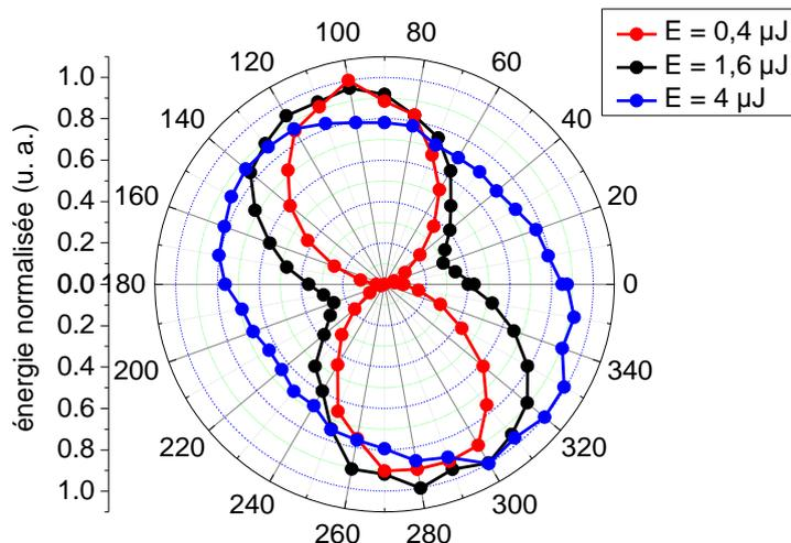
Figure 61 : Diagramme de polarisation de l'émission conique et du continuum de lumière blanche après filamentation dans un cristal de  $\text{CaF}_2$  de 1 cm d'épaisseur en fonction de l'énergie de l'impulsion laser incidente.
