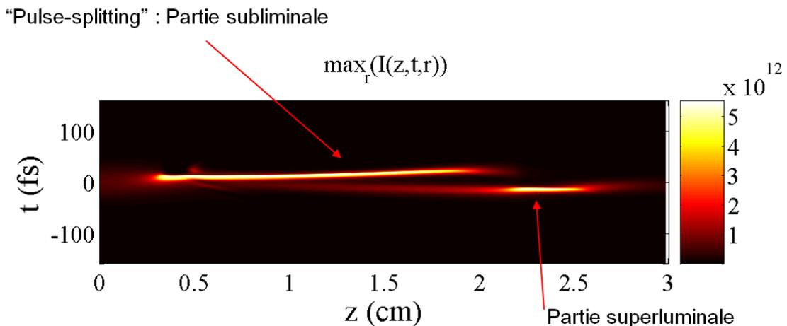
Figure 78 : Evolution temporelle d'une l'impulsion à  $1,9 \mu\text{m}$  ( $4 \mu\text{J}$ ,  $50 \text{ fs}$ ) au cours de sa propagation sous forme de filament. Mise en évidence d'une impulsion comprimée par filamentation à  $\sim 10 \text{ fs}$  et stable sur  $1,5 \text{ cm}$  (partie subliminale).
