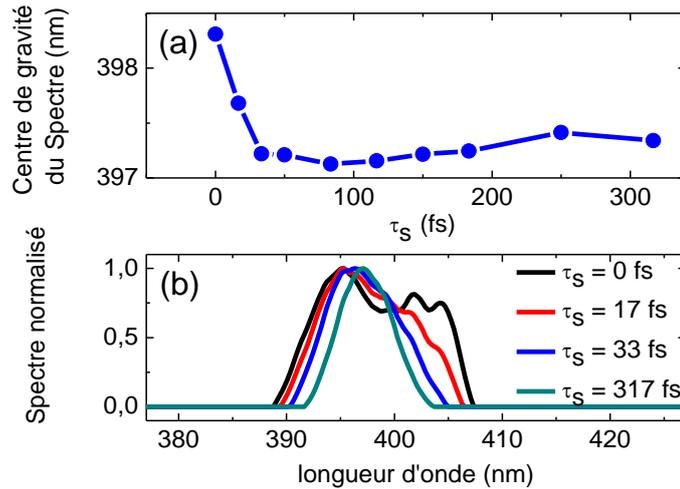
Figure 19 : Centre de gravité du spectre (a) et spectre normalisé (b) du signal sonde en fonction du retard  $\tau_s$ .
