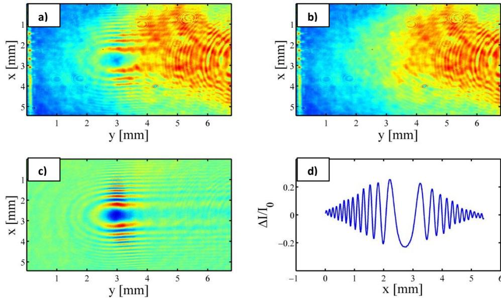
Figure 21 : Résultats obtenus lorsque le faisceau sonde arrive 1,13 ps après création du réseau de plasma dans l'air.
