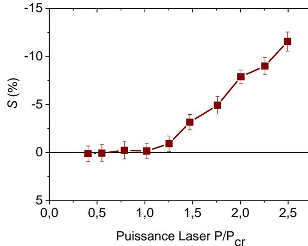
Figure 28 : Efficacité de l'échange d'énergie  $S$  en fonction du rapport  $P/P_{cr}$  dans l'Argon pour  $C = + 5$ .
