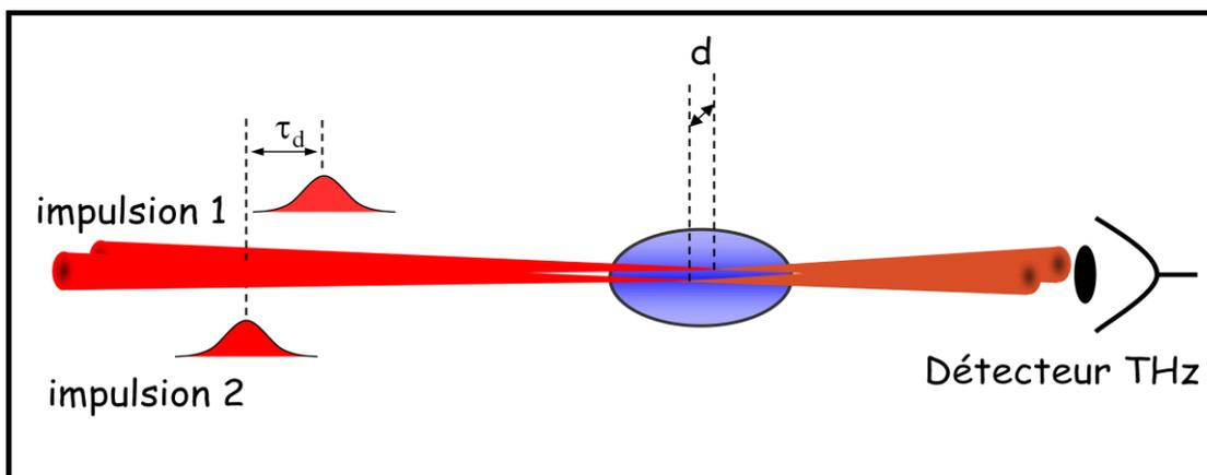
Figure 44 : schéma de principe de la bifilamentation laser
