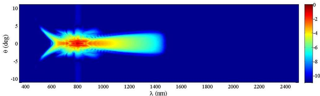
Figure 64 : Résultat de simulation numérique représentant la répartition angulaire  $\theta$  des longueurs d'onde  $\lambda$  générées au cours de la filamentation laser dans la silice pour  $\lambda_0 = 800 \text{ nm}$ .
