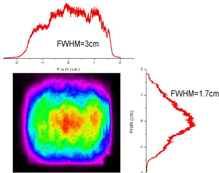
Figure 82 : Profil initial du faisceau laser
