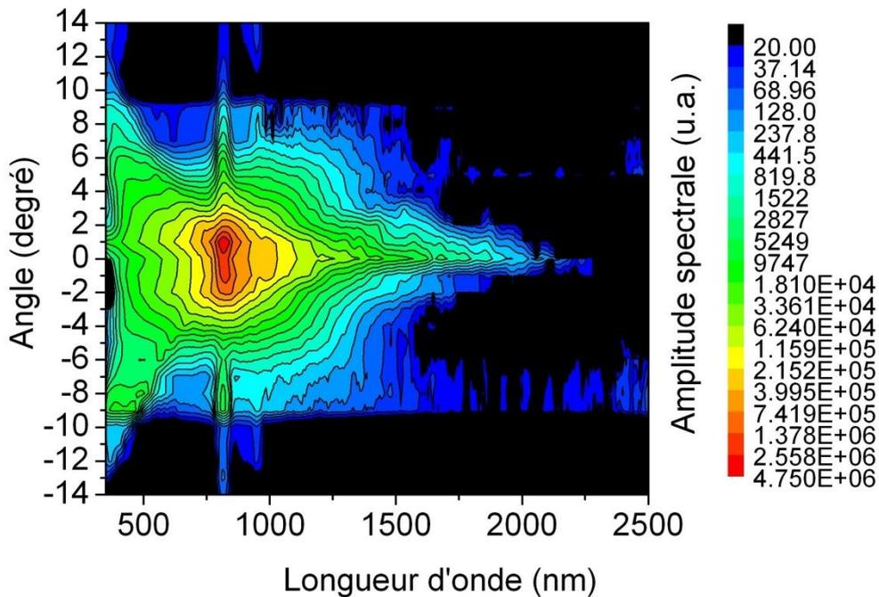
Figure 66 : Répartition spectrale de l'énergie en fonction de l'angle  $\theta$  pour  $\lambda_0 = 800$  nm dans la silice pour une énergie laser incidente de  $15 \mu\text{J}$ . Les niveaux de couleurs représentent l'amplitude des différentes longueurs d'onde.
