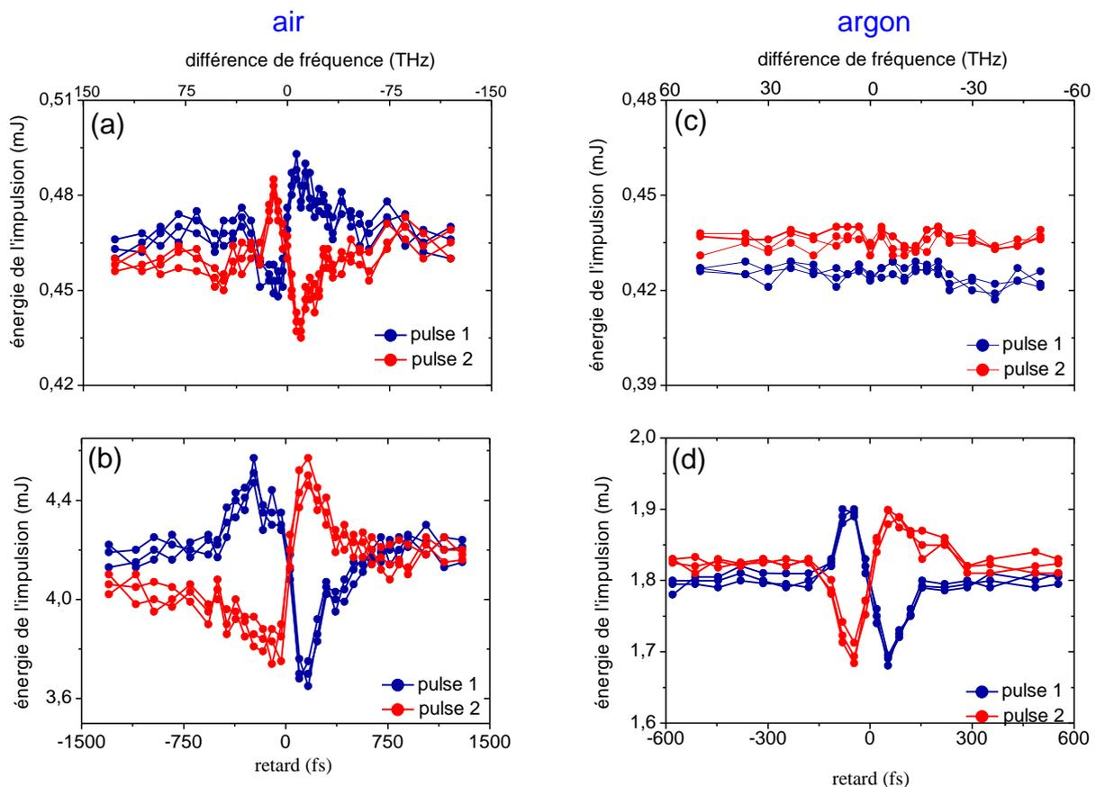
Figure 26 : Echange d'énergie dans l'air (a), (b) et dans l'argon (c), (d) pour  $P = 0,39 P_{cr}$  (a), (c) et  $P = 3,5 P_{cr}$  (b) et (d).
