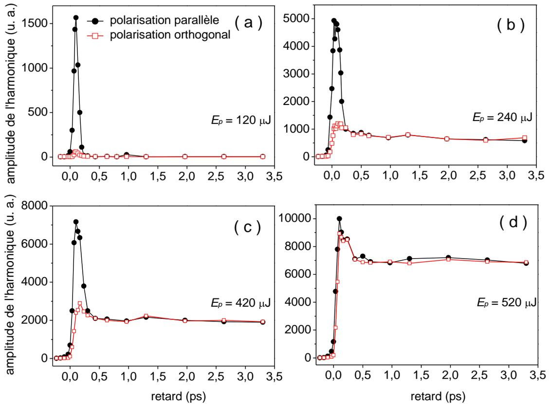
Figure 35 : Signal de la troisième harmonique en fonction du retard  $\tau_d$  pour différentes énergies et polarisations du faisceau pompe. L'angle  $\varphi$  entre les deux faisceaux est de  $90^\circ$ . L'énergie de l'impulsion signal est de  $320 \mu\text{J}$ .
