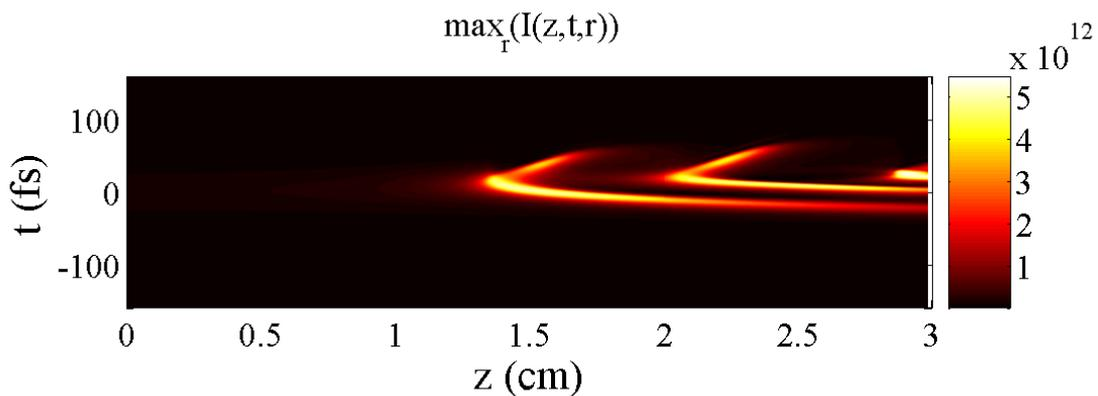
Figure 71 : Résultat de simulation représentant l'évolution temporelle d'une impulsion à  $1,2 \mu\text{m}$  ( $4 \mu\text{J}$ ,  $50 \text{fs}$ ) au cours de sa propagation sous forme de filament. Mise en évidence d'un phénomène de multiple « pulse-splitting ».
