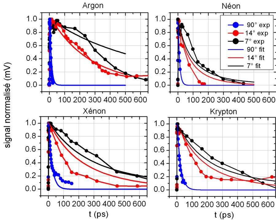
Figure 24 : Résultats expérimentaux et théoriques de l'évolution de l'efficacité de diffraction du réseau de plasma en fonction du retard  $t$  de la sonde par rapport au temps de création pour différentes valeurs de l'angle  $\varphi$ . Les points correspondent aux mesures expérimentales et les courbes continues aux ajustements théoriques.
