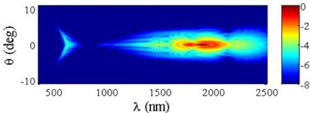
Figure 75 : Résultat de simulation numérique représentant la répartition angulaire  $\theta$  des longueurs d'onde  $\lambda$  générées au cours de la filamentation laser dans la silice pour  $\lambda_0 = 1,9 \mu\text{m}$ .
