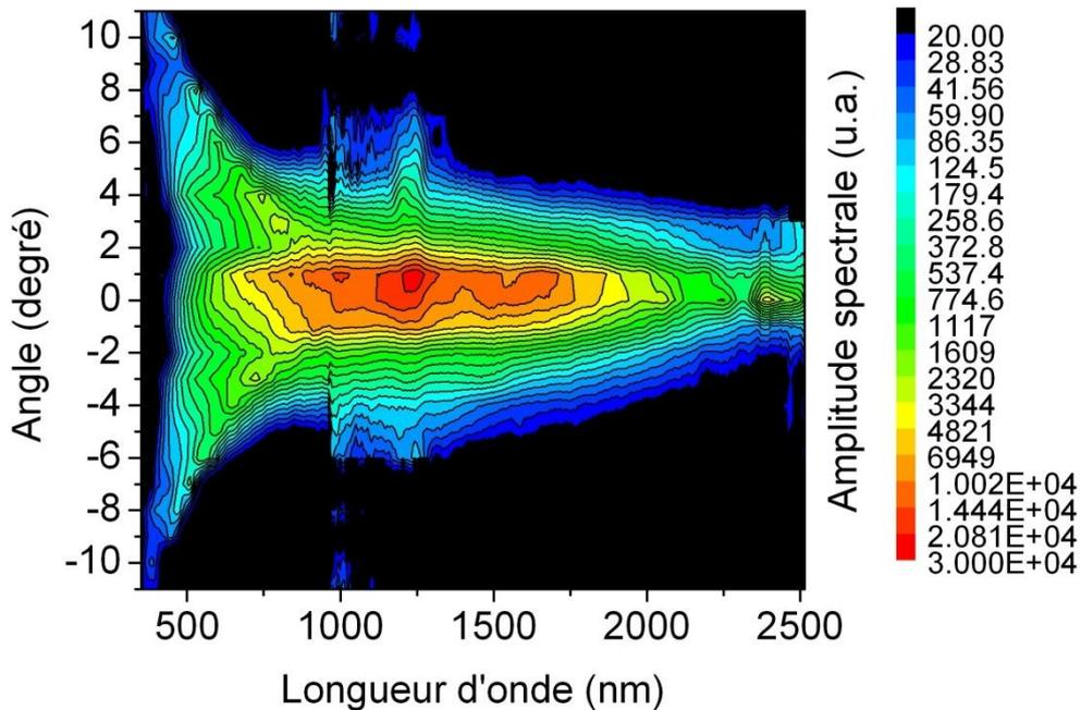
Figure 69 : Répartition spectrale de l'énergie en fonction de l'angle  $\theta$  pour  $\lambda_0 = 1,2 \mu\text{m}$  dans la silice pour une énergie laser incidente de  $E = 15 \mu\text{J}$ . Les niveaux de couleurs représentent l'amplitude des différentes longueurs d'onde.
