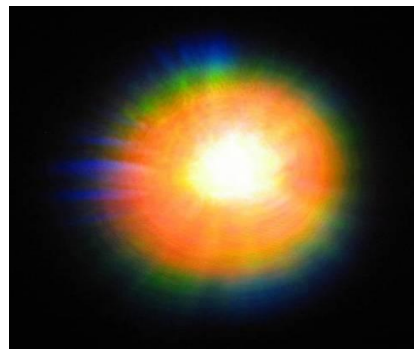
Figure 94 : Photographie de l'émission conique (diamètre 30 cm) produite par filamentation dans l'air à 145 m du faisceau laser T&T (campagne d'octobre 2009 dans le tunnel du RDDC Valcartier).
