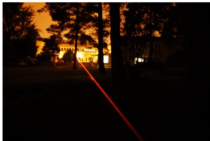
Figure 1 : Photographie de la propagation non-linéaire d'un faisceau TéraWatt issue de la chaîne laser ENSTAmobile à 200 m.
