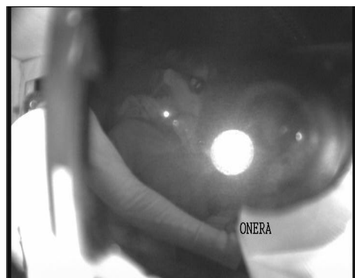
Figure 108 : Exemple d'image éblouie enregistrée à 1 500 m de la source laser.
