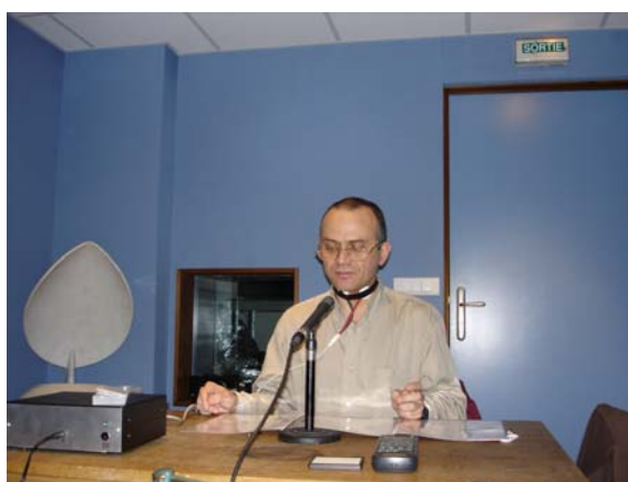
Figure 5 : enregistrement dans la chambre insonorisée de l'Institut de Linguistique et Phonétique Générales et Appliquées, Paris III. Le dispositif expérimental utilisé se compose du laryngographe équipé d'une paire d'électrodes de surface placée sur le cou du locuteur, d'un microphone et d'un Mini Disc .
