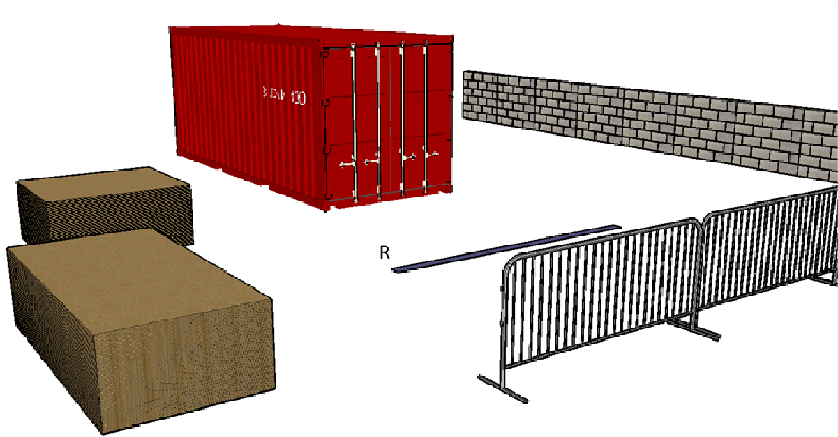
Figure 112 : Vue d'ensemble du dispositif de test « caisson 20 pieds ». L'incendie est allumé dans le container et les pompiers s'approchent du feu en marquant un temps d'arrêt au niveau du repère (R), marchent perpendiculairement au caisson et effectuent une approche afin d'éteindre l'incendie.
