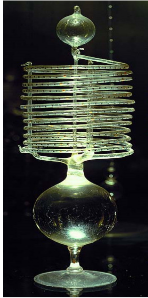
Figure 36 : Thermomètre à spirale de Galilée.
