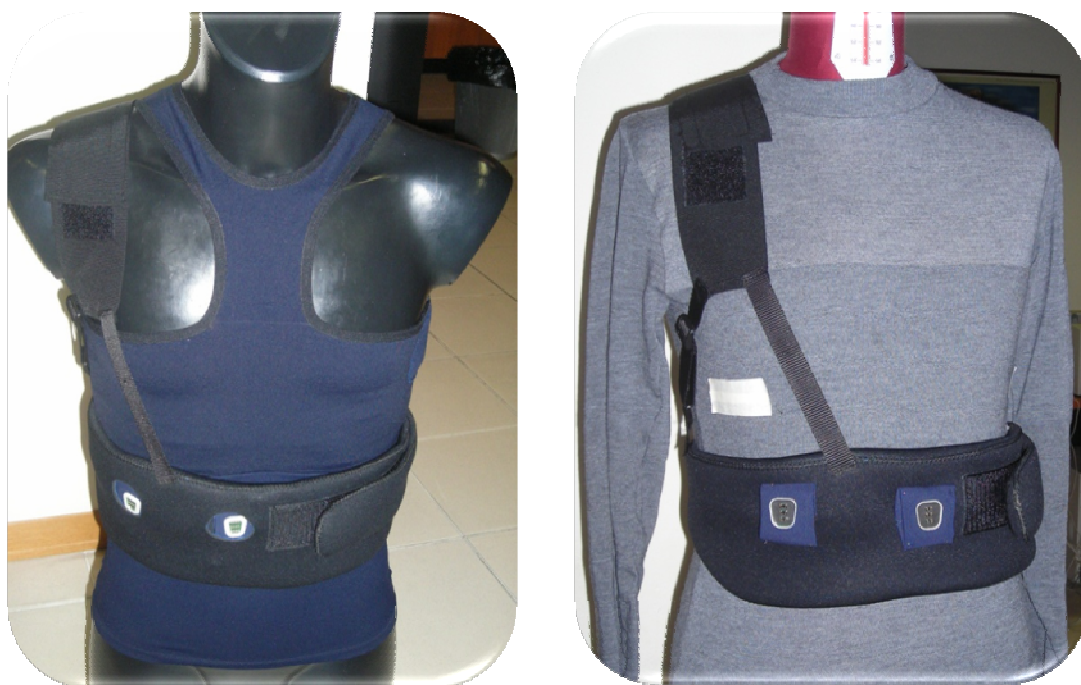
Figure 4 : Prototype ProeTEX 3 de tee-shirt. A gauche le tee-shirt de la sécurité civile, conçu en fibres synthétiques élastiques. A droite, le tee-shirt des pompiers, confectionné en coton. Seule la partie intégrant les électrodes est élastique pour améliorer le contact entre les électrodes et la peau.
