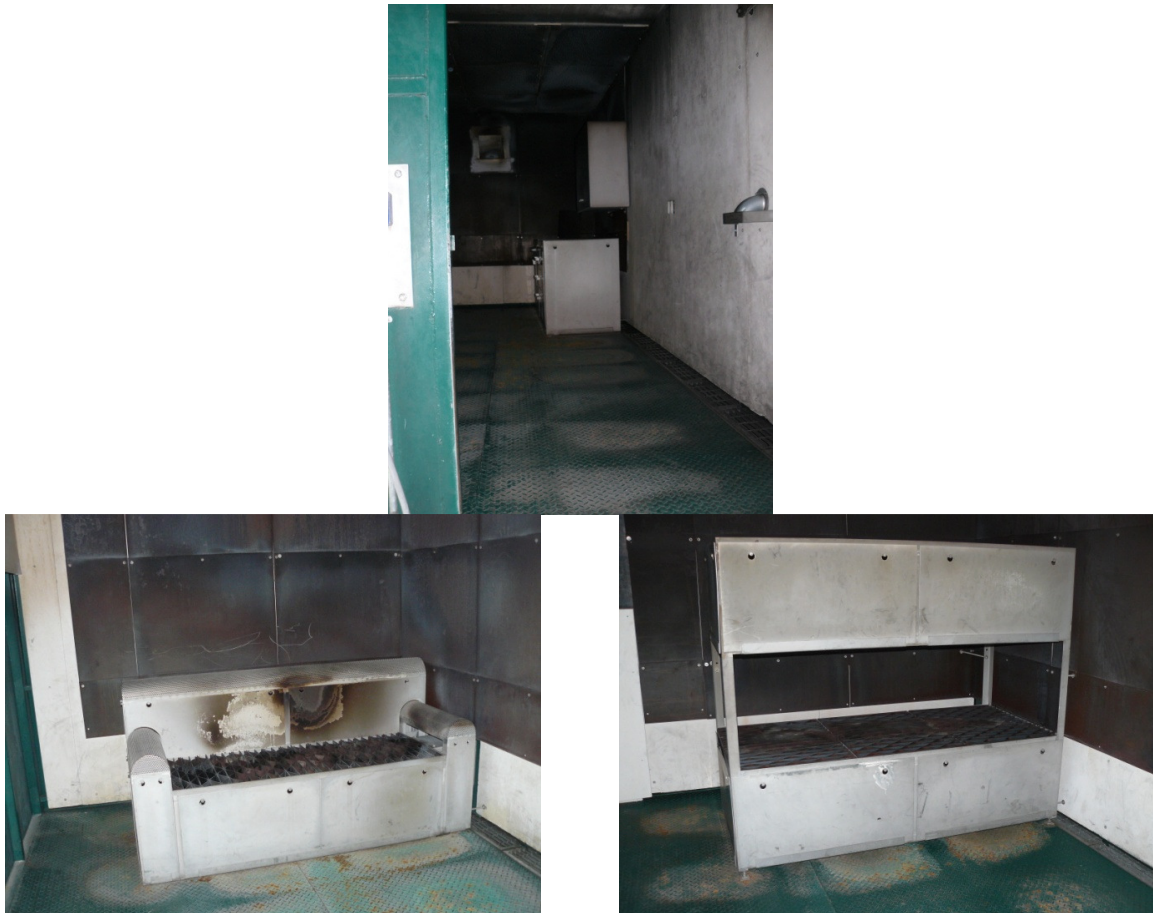
Figure 110 : Eléments de la maison du feu servant à la simulation des incendies. En haut : la gazinière, en bas à gauche : le canapé et en bas à droite : les lits superposés.
