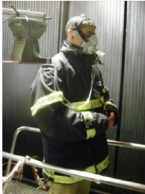
Figure 102 : Sujet dans la chambre climatique avant le début du test. Il est équipé du prototype à tester ainsi que de l'instrumentation de référence.
