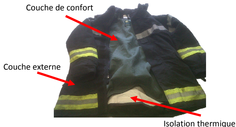
Figure 61 : Veste de pompier constituée de trois épaisseurs textiles : couche externe (bleu marine), isolation thermique (blanc) et couche de confort (vert).
