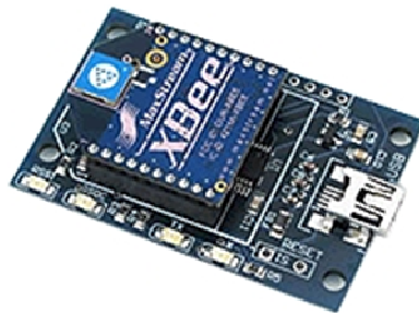
Figure 76 : Platine équipée d'un module XBee.
