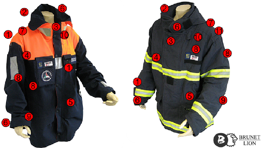
Figure 5 : Prototype ProeTEX 3 de veste. A gauche, le modèle sécurité civile et à droite, le modèle pompier. Les deux modèles n'intègrent pas tous les capteurs : 1 – Alarme visuelle (x1 dans le modèle pompier, x2 dans le modèle de la sécurité civile), 2 – Alarme acoustique, 3 – Capteur de température externe, 4 – Module Wifi, 5 – Module d'acquisition, 6 – Accéléromètre (x2), 7 – GPS, 8 – Antenne textile (x2), 9 – Batterie flexible, 10 – Capteur de CO, 11 – Fluxmètre (modèle pompier).
