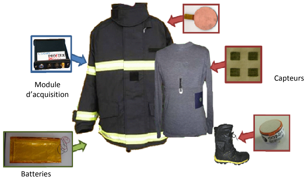
Figure 3: Vue d'ensemble du projet ProeTEX. Les capteurs (fluxmètres, électrodes pour l'ECG, capteurs de gaz, etc.), batteries et module d'acquisition et de communication sont intégrés dans les vêtements : veste, tee-shirt et bottes.
