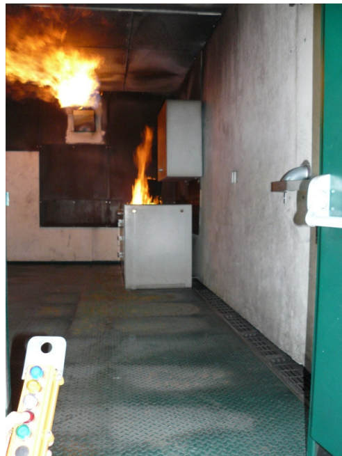
Figure 111 : Incendie dans la cuisine. Un foyer se situe au niveau de la gazinière. L'arrivée de gaz sur le mur à proximité du plafond permet de simuler le phénomène de roll-over (combustion des gaz accumulés au plafond).
