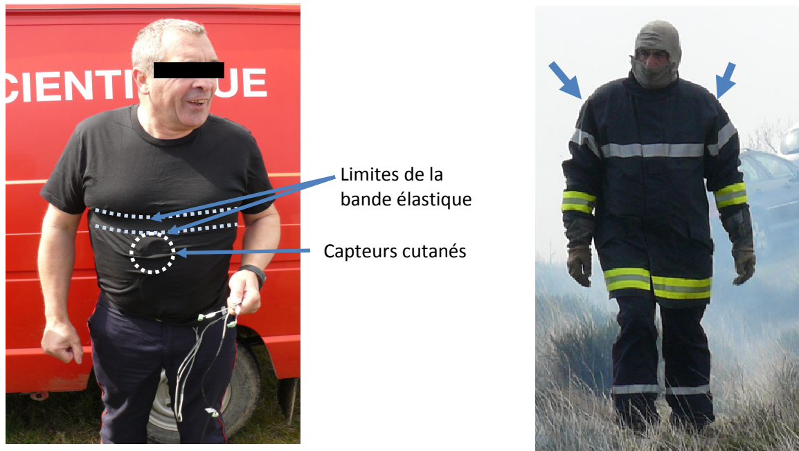
Figure 94 : Pompier équipé du tee-shirt instrumenté (à gauche). Les capteurs cutanés (fluxmètre et température cutanée) sont situés au niveau du thorax. Dans la veste (à droite) les capteurs sont positionnés au niveau des épaules.
