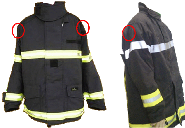
Figure 66 : Position des capteurs dans la deuxième prototype : un fluxmètre et une thermistance sont intégrés au niveau de chaque épaule, sous la couche externe de la veste.
