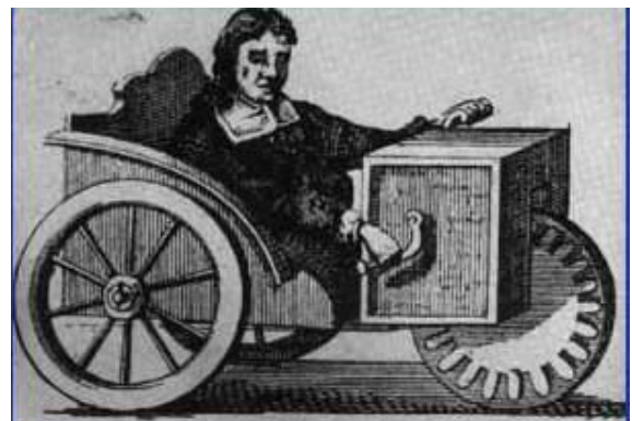
Figure 2 Premier fauteuil roulant à manivelles mis au point par Stephen Farfler en 1655.
