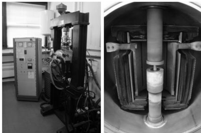
Figure IV-6 Photographie du dispositif hot pressing (à gauche); intérieur du four avec moule en graphite en position sur la presse (à droite)
