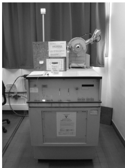
Figure II-2 Photographie du diffractomètre Philips PW3710 utilisé pour l'enregistrement des diagrammes RX.
