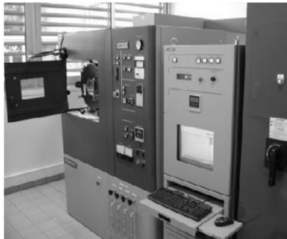
Figure IV-8 Machine Sumitomo 2080 de la Plateforme Nationale de Frittage Flash (CEMES, Toulouse)
