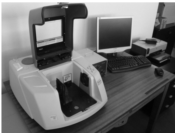
Figure II-10 Spectromètre infrarouge avec dispositif de mesure en transmission pour céramique.
