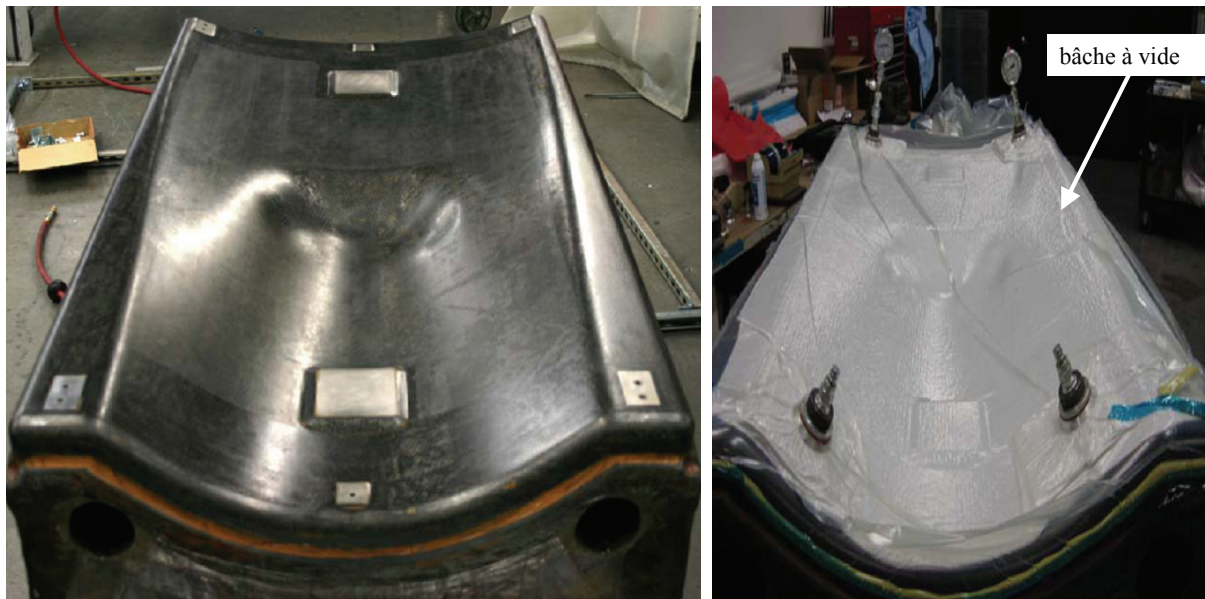
Figure 1-13: moule en Hextool™ pour RTM-Light (société NovaTech)
