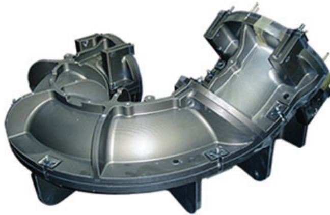
Figure 1-10: moule RTM utilisable en étuve (société PCM)
