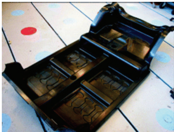
Figure 1-9: plancher composite moulé par technologie RTM [Binetruy06]
