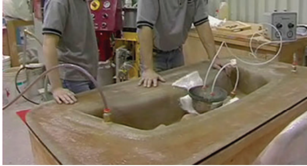
Figure 1-8: utilisation d'un outillage RTM-Light avec une bâche à vide (société PCM)
