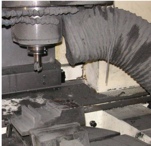
Figure 4-9: essais de puissance sur Huron KX15 avec dispositif d'aspiration
