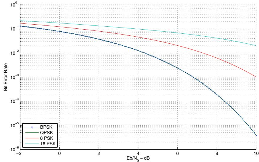
FIGURE 2.4 Courbes d'erreur binaire de plusieurs modulations PSK
