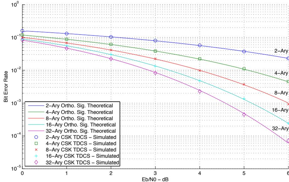
FIGURE 4.3 Taux d'erreur binaire d'un système TDCS - CSK
