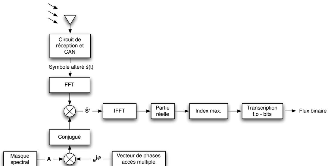
FIGURE 3.5 Récepteur TDCS-CSK implémenté à l'aide d'une transformée de Fourier
