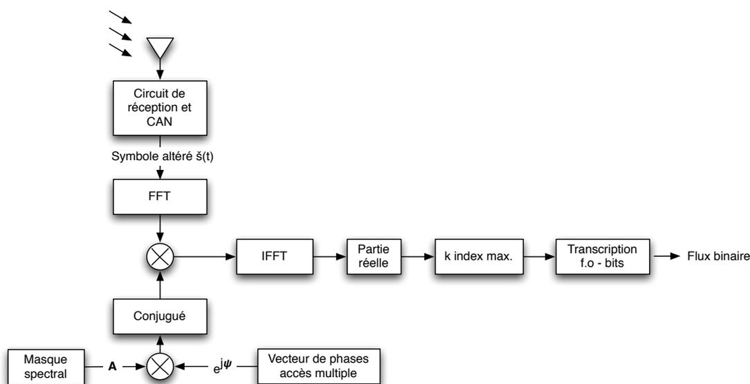
FIGURE 4.8 Récepteur TDCS à modulation  $k$  parmi  $N$
