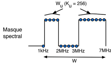
FIGURE 4.1 Gabarit spectral utilisé dans les simulations
