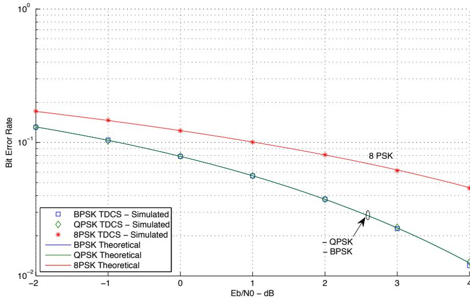
FIGURE 4.2 Taux d'erreur binaire d'un système TDCS - PSK
