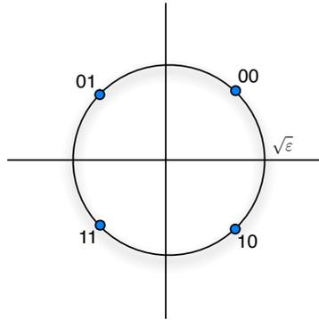
FIGURE 2.3 Constellation QPSK avec codage de Gray
