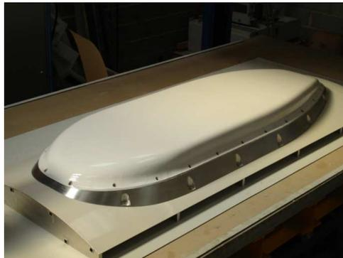
**FIGURE 1.2** Un premier prototype d'antenne sous radôme
