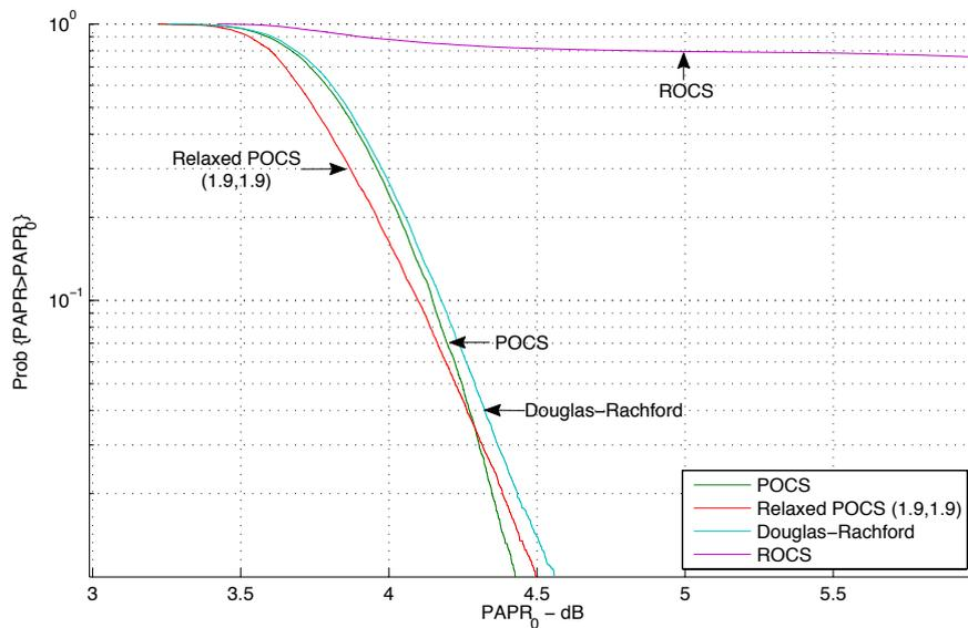
FIGURE 6.10 Fonctions de répartition pour un spectre non contigu et un PAPR cible de 3 dB
