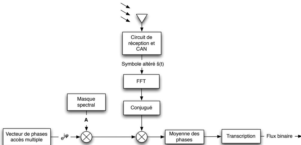
FIGURE 3.6 Récepteur TDCS-PSK implémenté par simple moyenne
