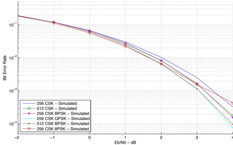
FIGURE 4.7 Taux d'erreur binaire d'un système TDCS - PSK-CSK
