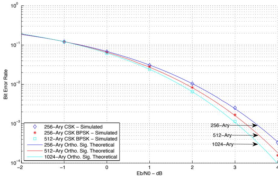
FIGURE 4.5 Taux d'erreur binaire d'un système TDCS - CSK-BPSK
