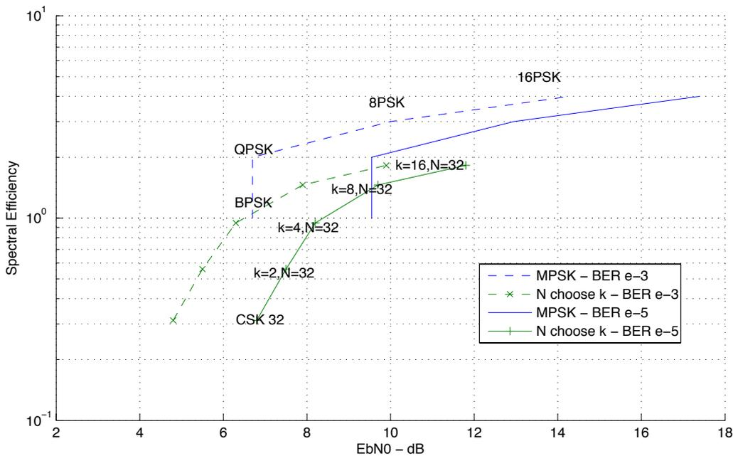
FIGURE 4.11 Comparaison de l'efficacité spectrale pour deux BER cibles
