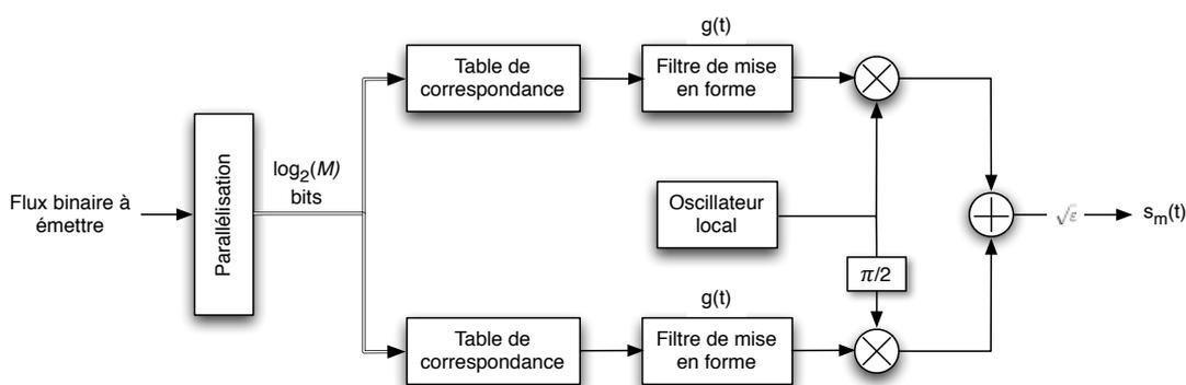
FIGURE 2.2 Implémentation possible de la modulation PSK
