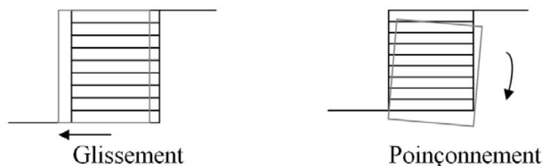
Figure 11. Mécanismes de ruine de glissement et de poinçonnement à considérer dans le cadre d'une vérification de stabilité externe.
