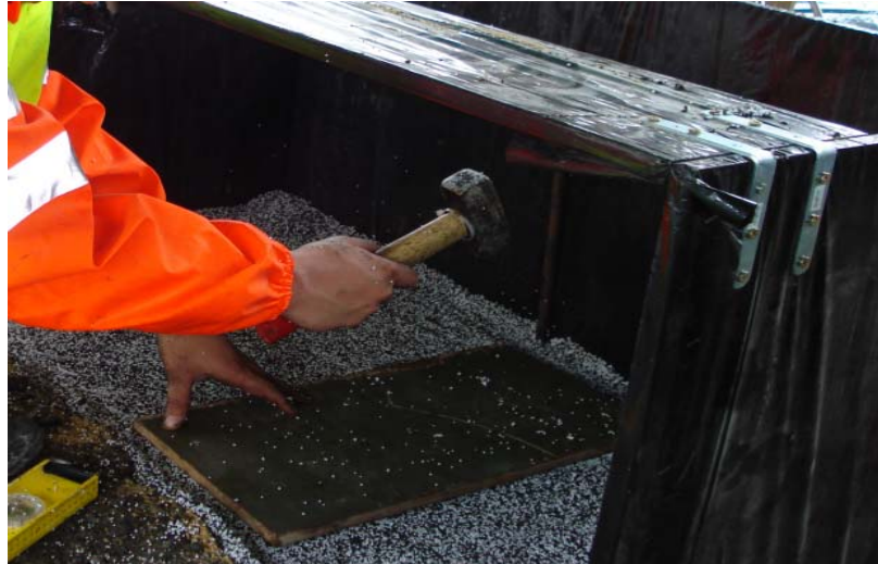
Figure 94. Deuxième étape de compactage du matériau
