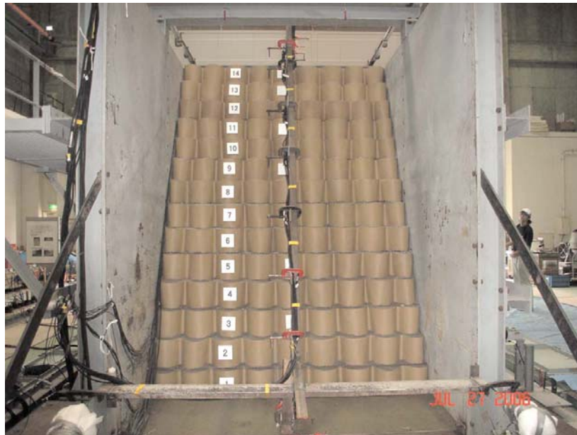
Figure 25. Exemple sur table vibrante d'un ouvrage de soutènement renforcé par géocellulaires en vraie grandeur [LES et al. 09].
