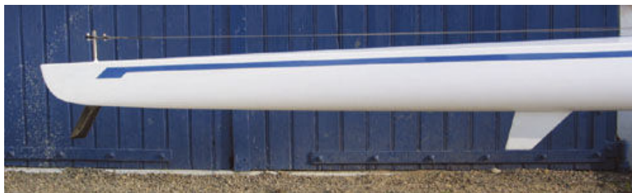
Figure I.14 – Dérive (blanche) et safran (noir) d'un bateau d'aviron
