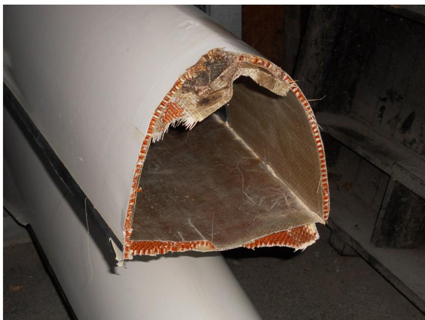
**Figure I.4** – Coupe d'un bateau d'aviron endommagé montrant sa structure composite fibre de verre/nid d'abeille
