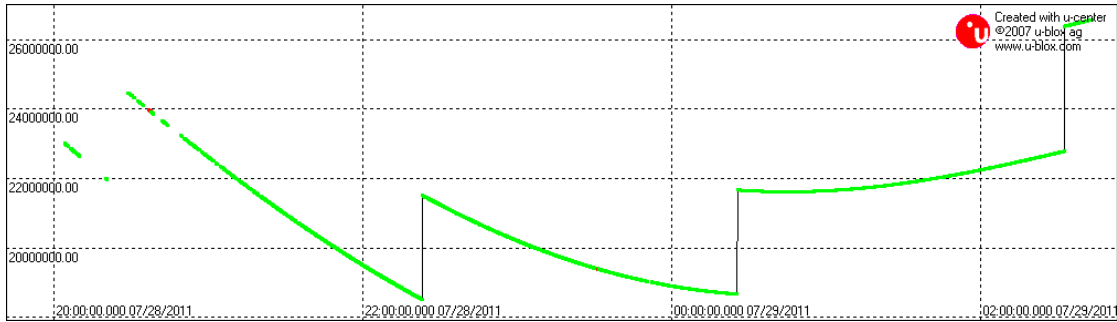
Figure 5.11: Influence des sauts d’horloge sur les pseudodistances mesurées (en m) du satellite 24.
