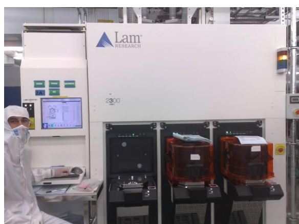
Figure 2-2 : photographie et représentation schématique de la plate-forme de gravure LAM Versys
