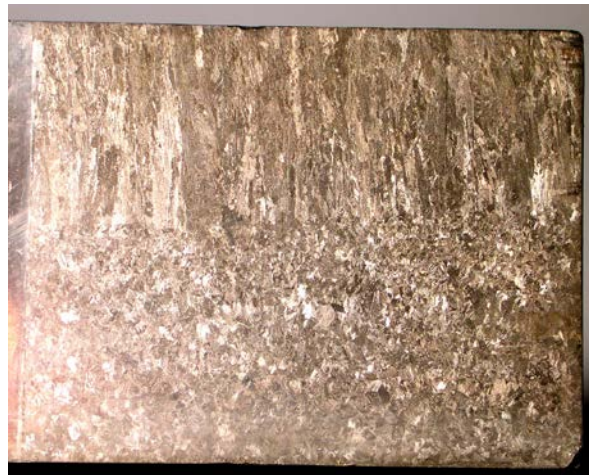
Figure 5-8 : Macrographie axiale réalisée sur la coulée TMV – épaisseur 66 mm.
