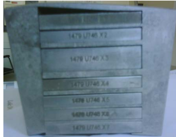
Matériau U746 : 7 échantillons (X1 à X7) Dimensions 60 x 60 mm 2 (épaisseur 6 ou 12mm)
