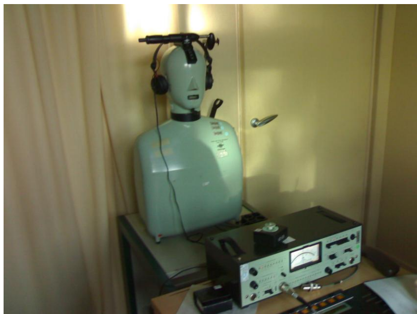
Figure 1 Etalonnage des bruits de fond à l'aide de la tête acoustique BRUEL & KJAER
