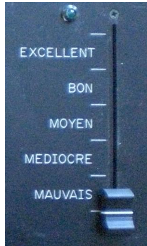
Fig. III.4 Interface du test d'évaluation de la qualité vocale (adapté du test ACR)
