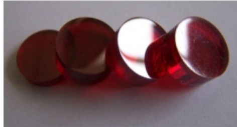
Figure V.3 : Échantillons en As_2S_3 polis, à faces parallèles.
