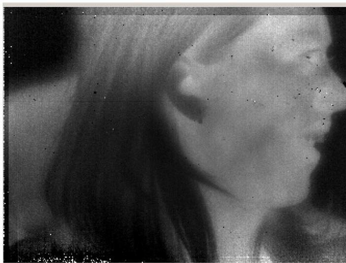
**Figure D-2 : Première image obtenue avec le bolomètre courbé**
