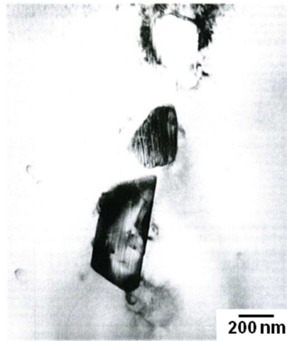
Figure I-3 : Microstructure de précipités de Zr(Cr, Fe)_2 (Cox et al. 1998)
