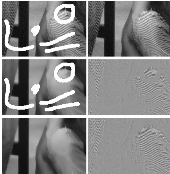
Figure 1.38 – Décomposition des images pour l’ inpainting des zones blanches sur l’image source Barbara par l’algorithme présenté dans [BVS03].
