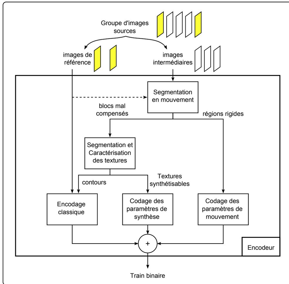
Figure 5.5 – Schéma bloc du codeur proposé.
