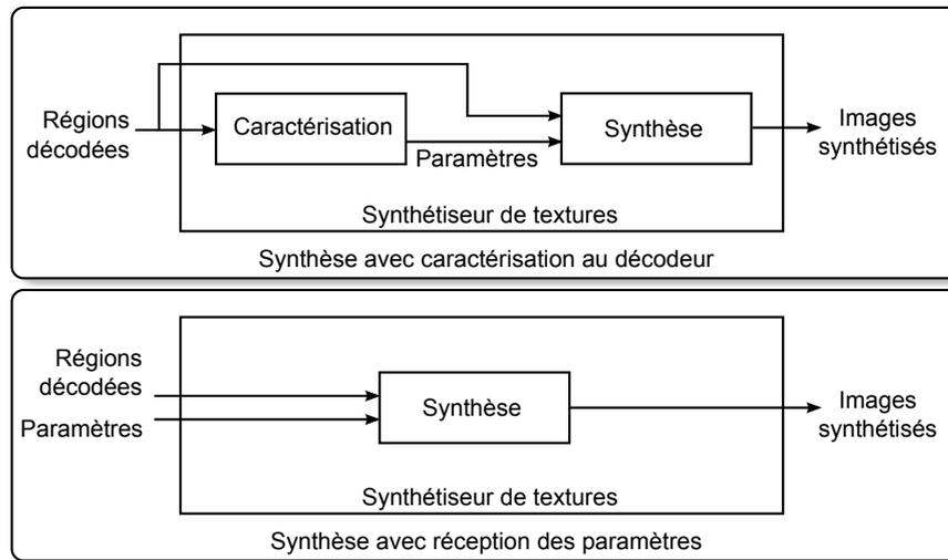
**Figure 4.5** – Schéma bloc de la synthèse réalisée au décodeur. Dans le premier cas, une étape de caractérisation permet de déterminer les paramètres grâce aux zones déjà décodées. Dans le second, ces informations sont reçues comme information supplémentaire.
