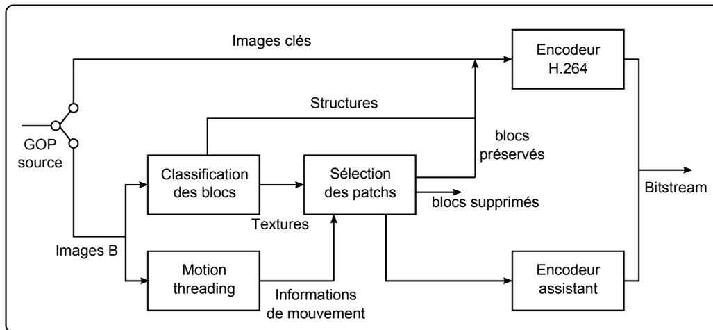
Figure 2.23 – Schéma du codeur présenté dans [ZSWL07]
