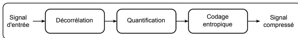
Figure 2.4 – Structure générale d'un schéma de compression d'images.
