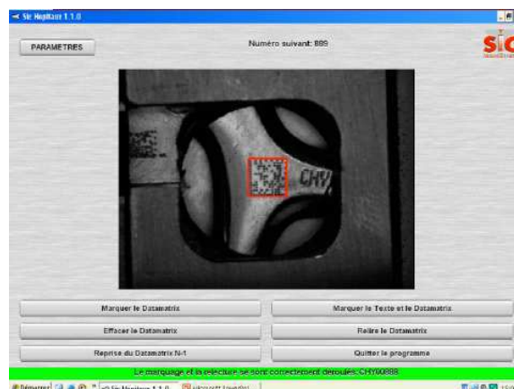
Figure 4 : Exemples d'instruments disposant d'une code-à-barres data matrix gravé par micropercussion
