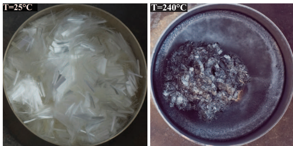
FIGURE 2.9: Échantillon de fibres PAN à température ambiante puis après le cycle à la température de consigne de 200°C.
