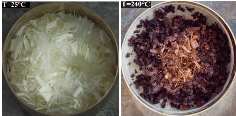
FIGURE 2.8: Échantillon de fibres PVA à température ambiante puis après le cycle à la température de consigne de 200°C.
