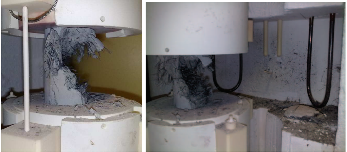
FIGURE C.3: Reste de l'échantillon CSB6.35_9_1480 à l'issue de l'essai en compression simple à 750°C
