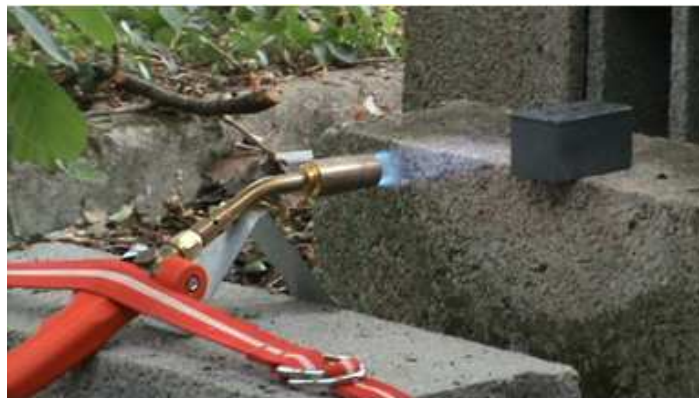
FIGURE 2.21: Capture d'image de l'installation de l'essai au chalumeau.
