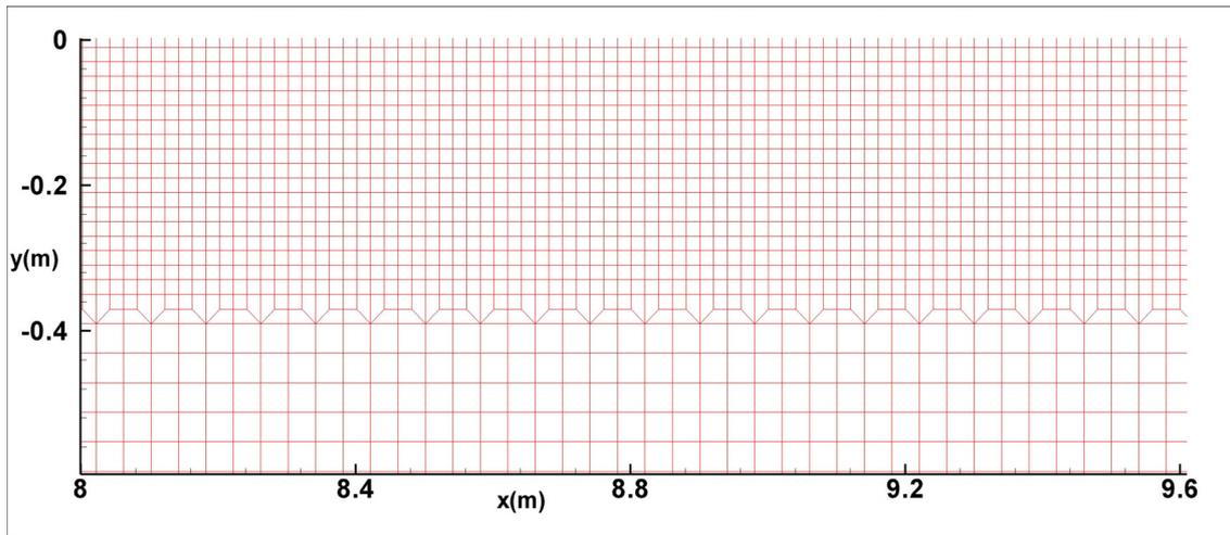
Fig.6.12: Propagation d'onde: Maillage du domaine de calcul
