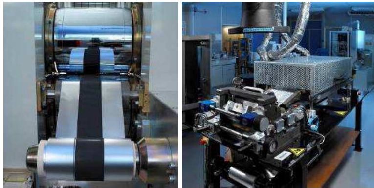
Figure 2-32. Banc d'enduction utilisé au laboratoire pour la préparation d'électrodes bifaces.
