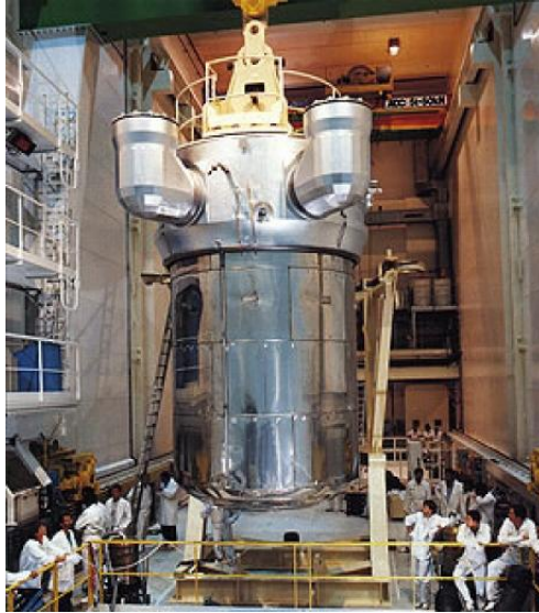
FIGURE 3.43: Photographie d'une cuve d'un réacteur nucléaire constituée d'acier (©Istockphotos).
