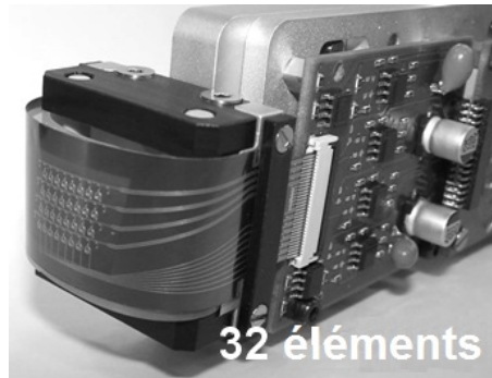
FIGURE 3.3: Sonde à courants de Foucault composée de 32 éléments de type micro-bobines gravées sur un film de Kapton (MARCHAND, DECITRE et CASULA 2008) et (MARCHAND, DECITRE et CASULA 2010).
