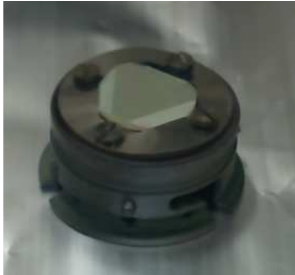
Figure 3 : Photo du substrat de \text{TiO}_2(110) posé sur le porte-échantillon (traitement de ses pièces en molybdène avec AlTiN).
