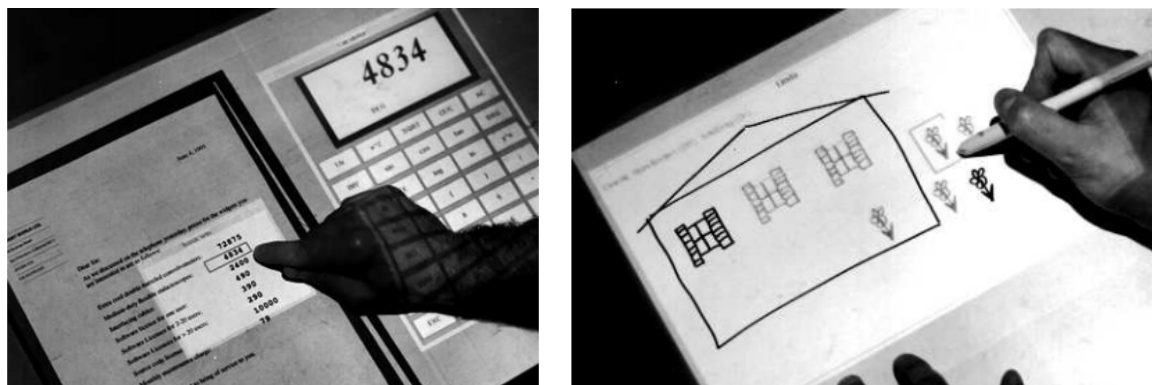
(a) Redirection de la calculatrice PC sur bureau interactif (b) Redirection d'un logiciel de dessin type Paint sur bureau interactif
