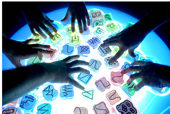
(b) La reactable proposée par et Jordà et al. [91] permettant d'interagir avec des objets tangibles pour la conception musicale
