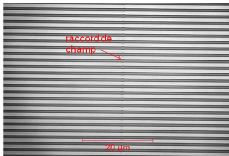
Figure 3.12 : Photographie d'un réseau sur le masque-test observé au microscope confocal. Ce réseau de lignes présente un pas de 3.96 \mu\text{m} avec un rapport d'ouverture égal à 50%.
