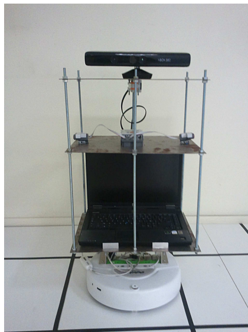
FIGURE 4.18 – iRobot Create surmonté d'une plateforme portant un ordinateur portable, des capteurs à ultra-son reliés à une brique NXT et un Kinect.
