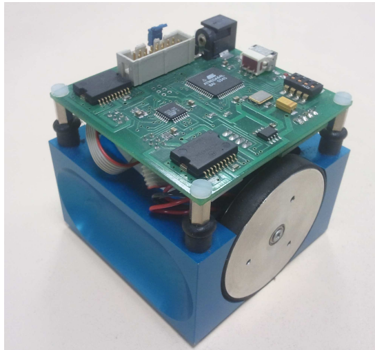
FIGURE 4.19 – Miabot, petit robot à deux roues produit par Merlin Robotics.
