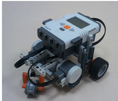
FIGURE 4.17 – Exemple de robot à deux roues indépendantes Lego NXT.
