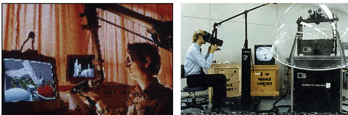
FIG. 1.2 – Exemples de système : A gauche, le système de téléopération du CEA/CEREM ; A droite, le système de téléprésence avec un robot mobile du groupe de recherche en téléprésence “California Corporation Telepresence Research”
