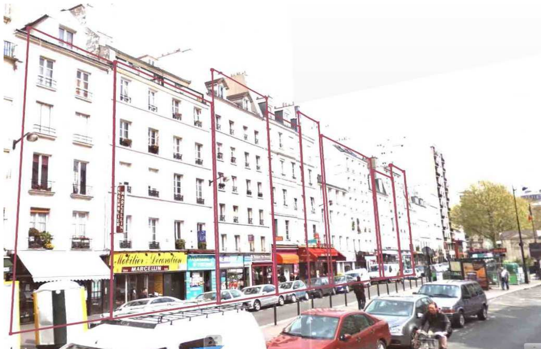
Figure A.6: Modèle en fil de fer 3D de façades urbaines estimé à l'échelle de la rue à partir des données lasers et projetés dans une image panoramique de la scène associée.
