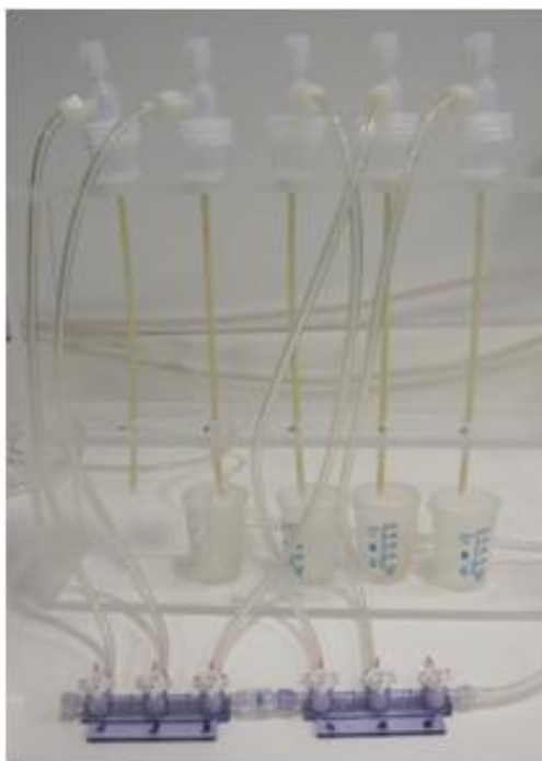
figure 40 : Colonnes à résine échangeuse d'anions – dispositif sous pression d'azote (0,6 bar).
