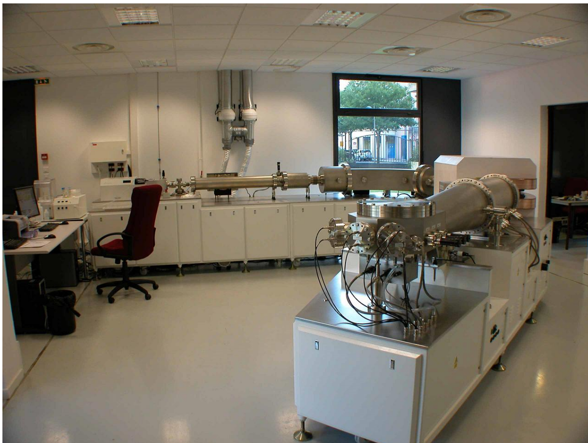
figure 34 : Spectromètre de masse à multicollecion Nu 1700 de l'ENS de Lyon. Photographie : P. Télouk.
