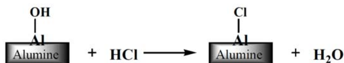
Figure 3 – Substitution des hydroxyles de la surface de l'alumine par chloration, exemple de HCl
