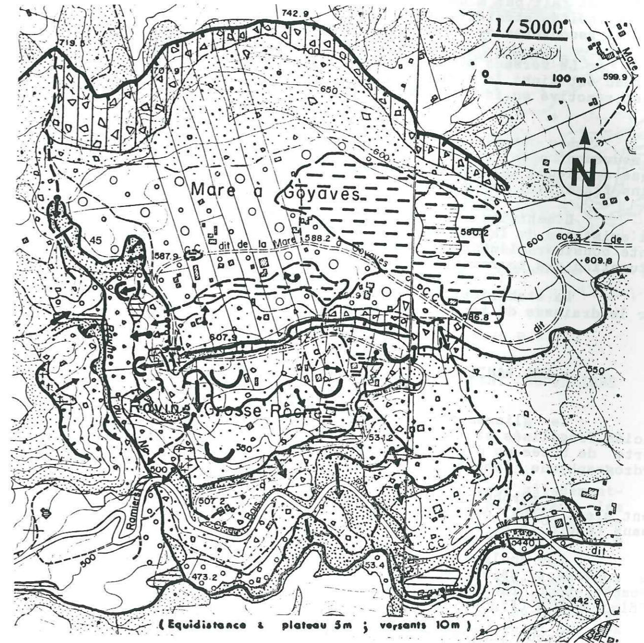
FIG. 58 : CARTE GEOTECHNIQUE D'UN GLISSEMENT-TASSEMENT EN MASSE DE FLANC DE VALLEE, A MARE A GOYAVES
