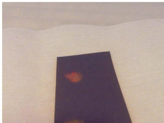
**Figure 5: Photographie d'un échantillon sur lequel on a effectué un tir laser :  $P = 120 \text{ mJ/cm}^2, 2 \text{ pulses}$ .**
