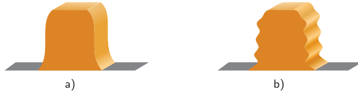
Figure A.7 – Profil d'une ligne de résine après développement : a) sans ondes stationnaires, b) avec ondes stationnaires.
