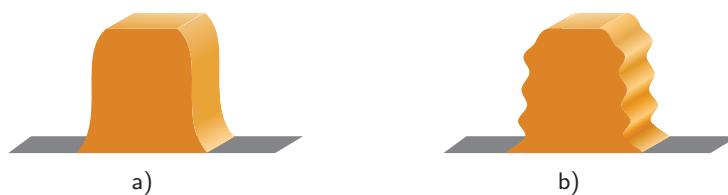
Figure 1.4 – Profil d'une ligne de résine après développement : a) sans ondes stationnaires, b) avec ondes stationnaires.
