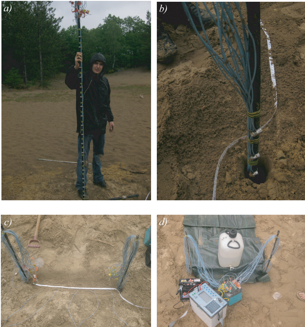
FIGURE IV.1 – Mise en place du dispositif de mesures développé pour les tests de terrain préliminaires. a) Le système de mesures est constitué de deux perches ayant 21 électrodes espacées de 10 cm. b) Chaque perche est enfouie verticalement dans une zone sableuse tabulaire dont l'épaisseur minimale est estimée à 3 m. c) Un fossé de 10 cm de profondeur est creusé entre les deux puits distants de 90 cm et 5 électrodes de surface espacées de 15 cm sont ajoutées dans le fossé. d) Le creux est recouvert d'un tissu perméable puis rempli par un traceur contenant 1,2 \text{ g.L}^{-1} de NaCl à \rho_f = 4,3 \text{ } \Omega.m . L'acquisition des données est réalisée automatiquement par une centrale d'acquisition.
