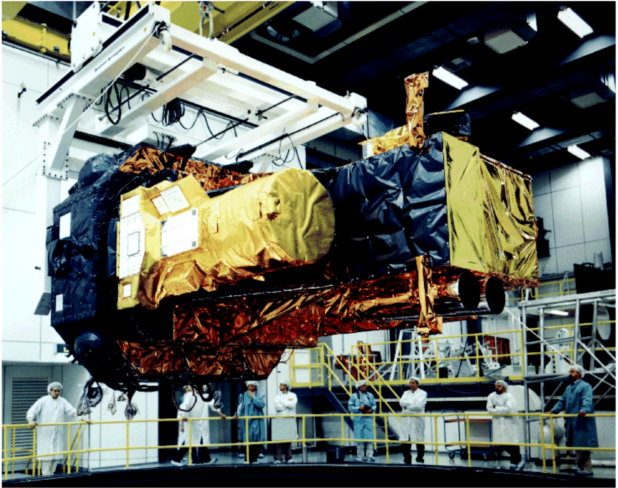
La mission Integral quelques semaines avant le lancement ; on reconnaît devant le spectromètre SPI, et à l'arrière l'imageur Ibis
