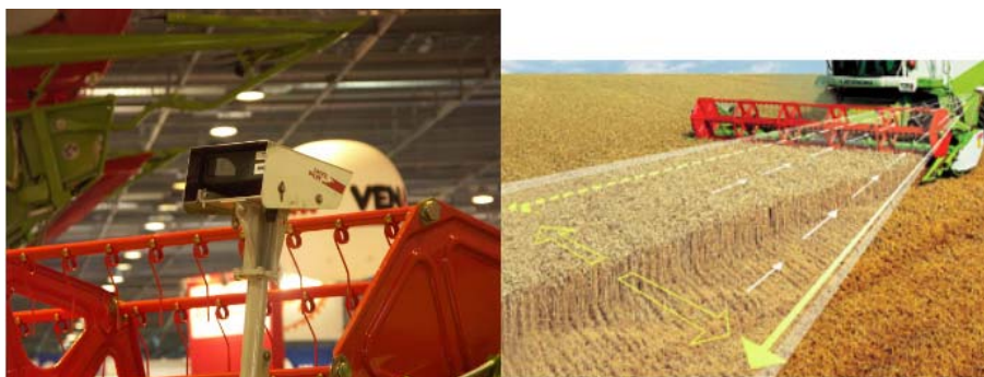
FIG. 2.2 – Système de guidage par laser AutoPilot - CLAAS 1997
