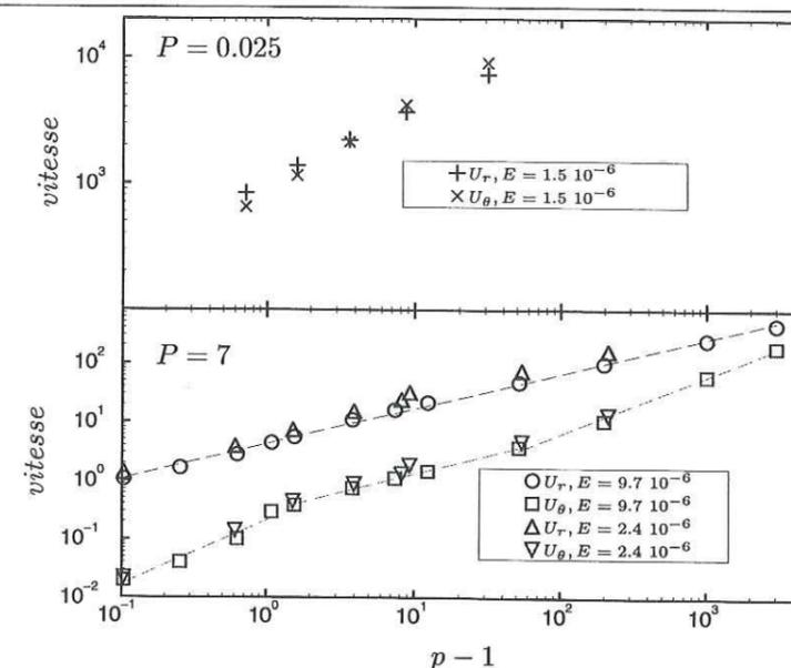
FIG. 3.26 – Vitesses rms convective et zonale en fonction de la déviation au flux de chaleur au seuil.
