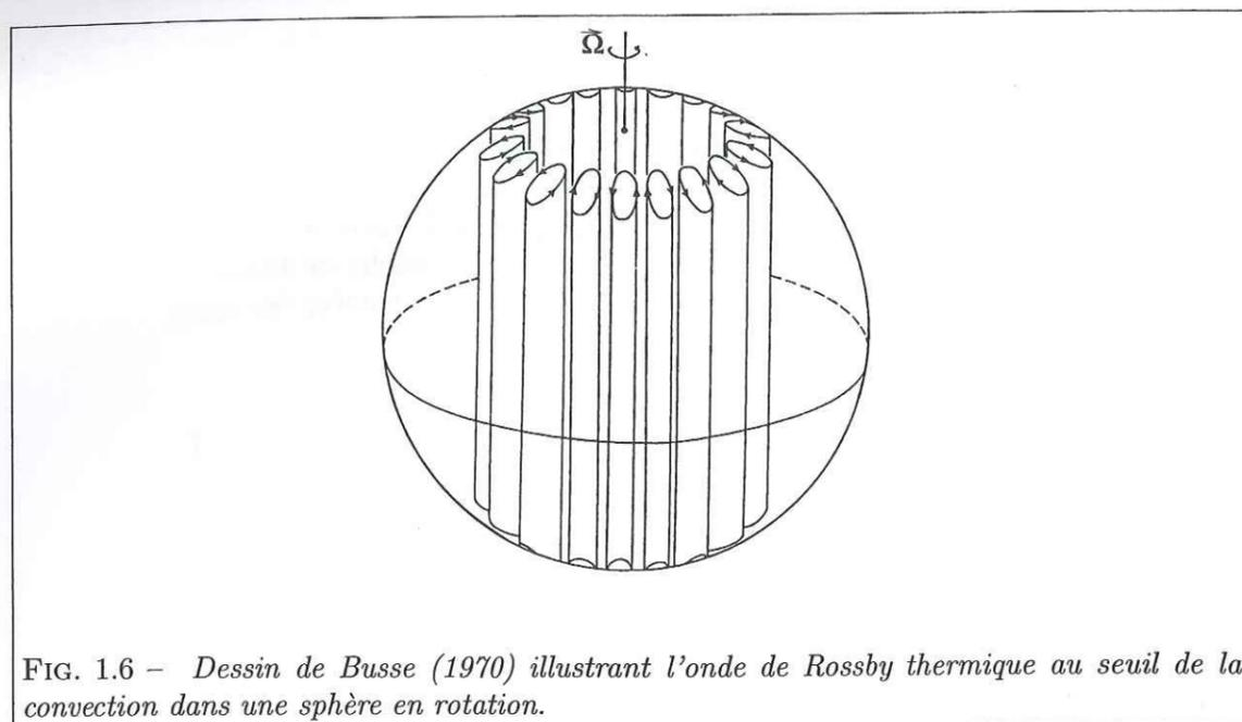
FIG. 1.6 – Dessin de Busse (1970) illustrant l'onde de Rossby thermique au seuil de la convection dans une sphère en rotation.
