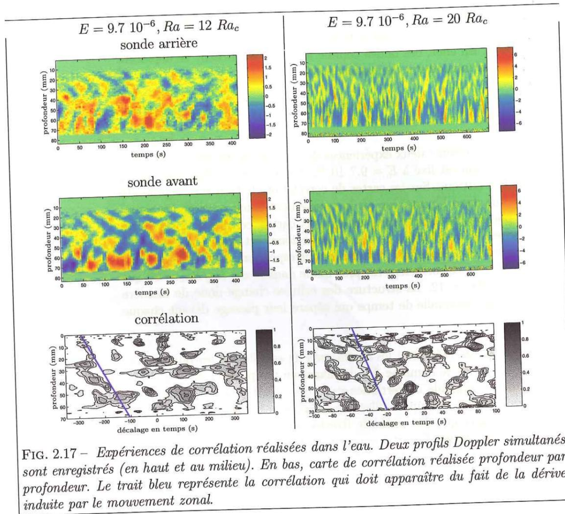
FIG. 2.17 – Expériences de corrélation réalisées dans l'eau. Deux profils Doppler simultanés sont enregistrés (en haut et au milieu). En bas, carte de corrélation réalisée profondeur par profondeur. Le trait bleu représente la corrélation qui doit apparaître du fait de la dérive induite par le mouvement zonal.
