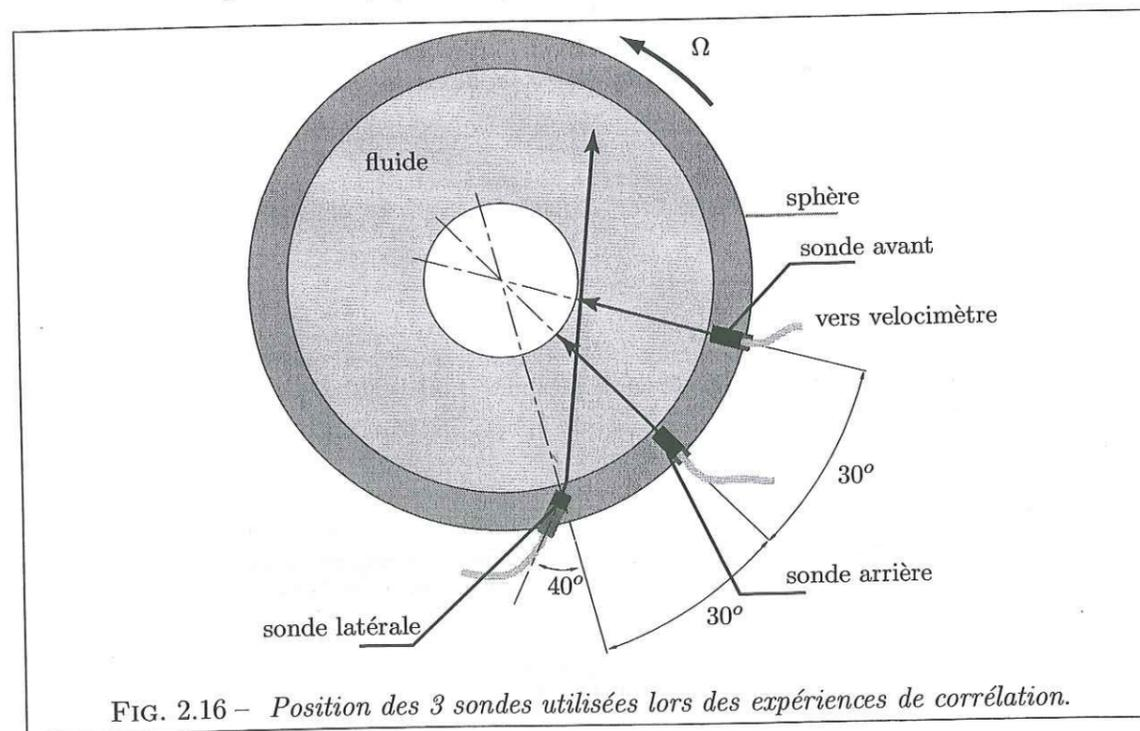
Un multiplexage nous permet d'acquérir un profil sur les sondes arrière et avant de manière quasi-simultanée. On enregistre aussi le profil de mouvement
