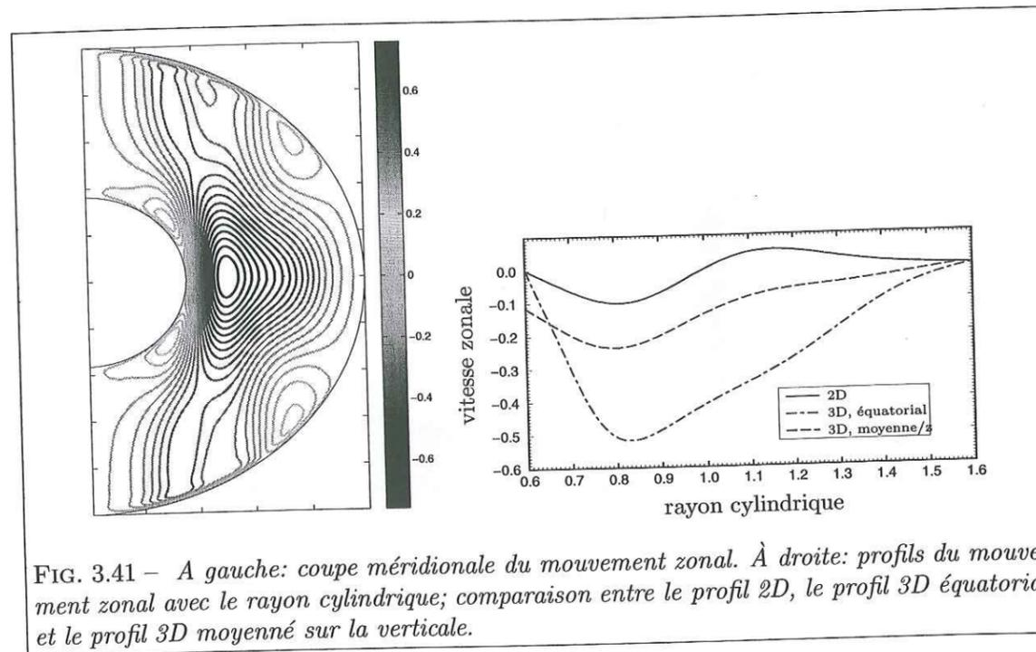
FIG. 3.41 – A gauche: coupe méridionale du mouvement zonal. À droite: profils du mouvement zonal avec le rayon cylindrique; comparaison entre le profil 2D, le profil 3D équatorial et le profil 3D moyenné sur la verticale.
