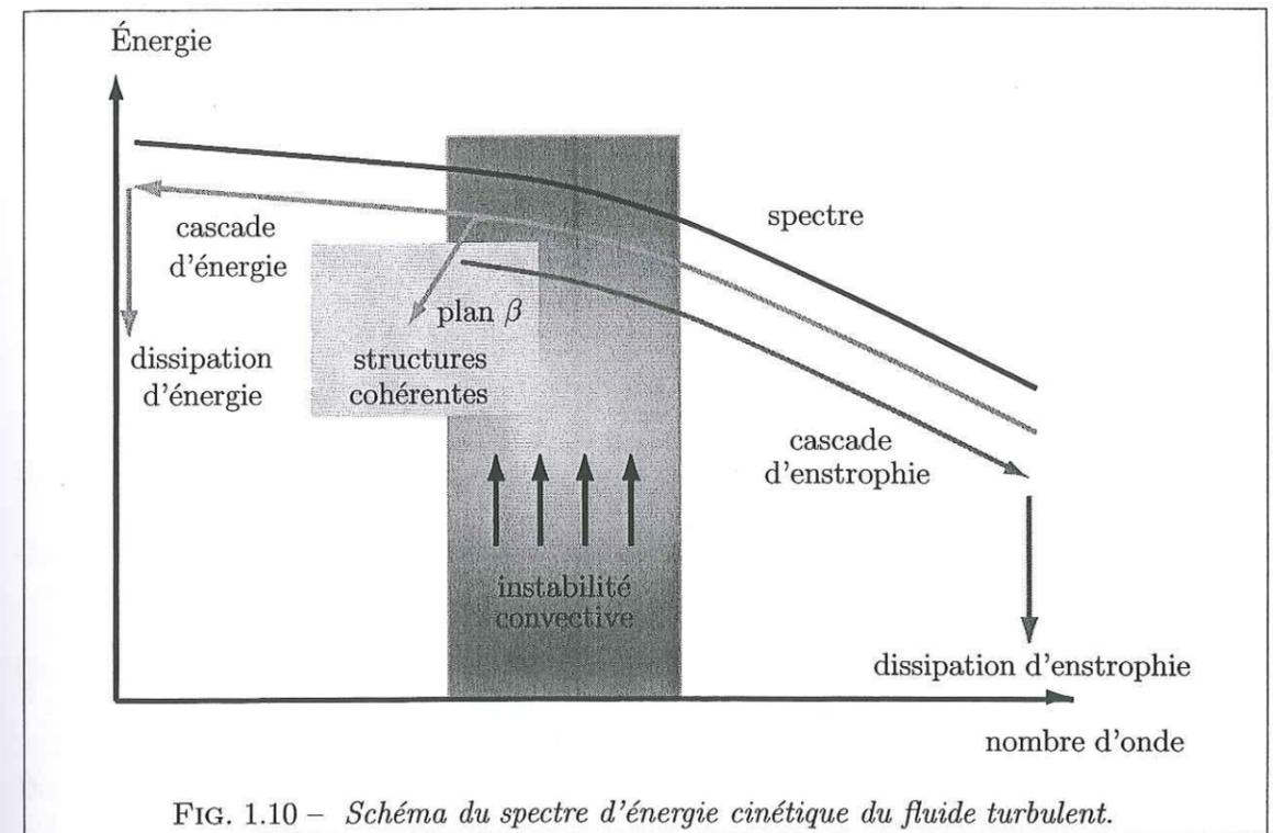
FIG. 1.10 – Schéma du spectre d'énergie cinétique du fluide turbulent.
