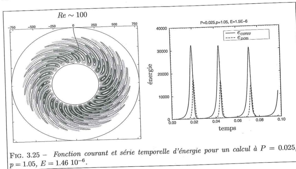
FIG. 3.25 - Fonction courant et série temporelle d'énergie pour un calcul à  $P = 0.025$ ,  $p = 1.05$ ,  $E = 1.46 \cdot 10^{-6}$ .
