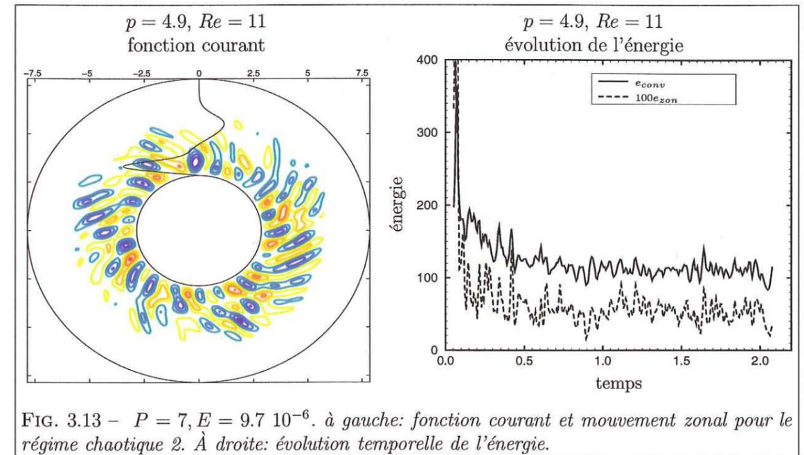
FIG. 3.13 -  $P = 7, E = 9.7 \cdot 10^{-6}$ . à gauche: fonction courant et mouvement zonal pour le régime chaotique 2. À droite: évolution temporelle de l'énergie.
