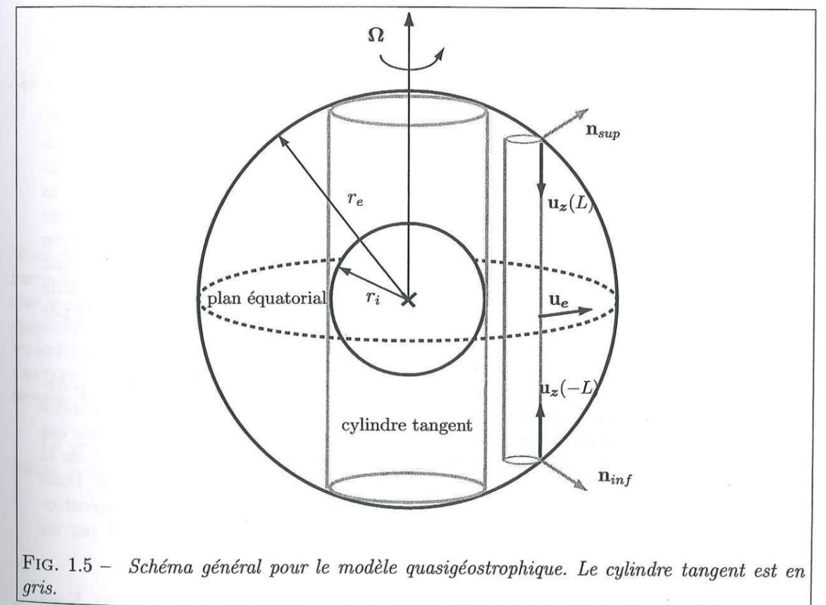
FIG. 1.5 – Schéma général pour le modèle quasigéotrophique. Le cylindre tangent est en gris.
