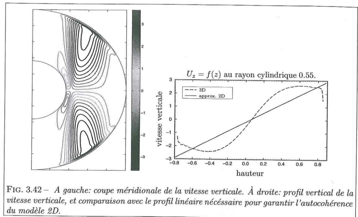
FIG. 3.42 – A gauche: coupe méridionale de la vitesse verticale. À droite: profil vertical de la vitesse verticale, et comparaison avec le profil linéaire nécessaire pour garantir l'autocohérence du modèle 2D.
