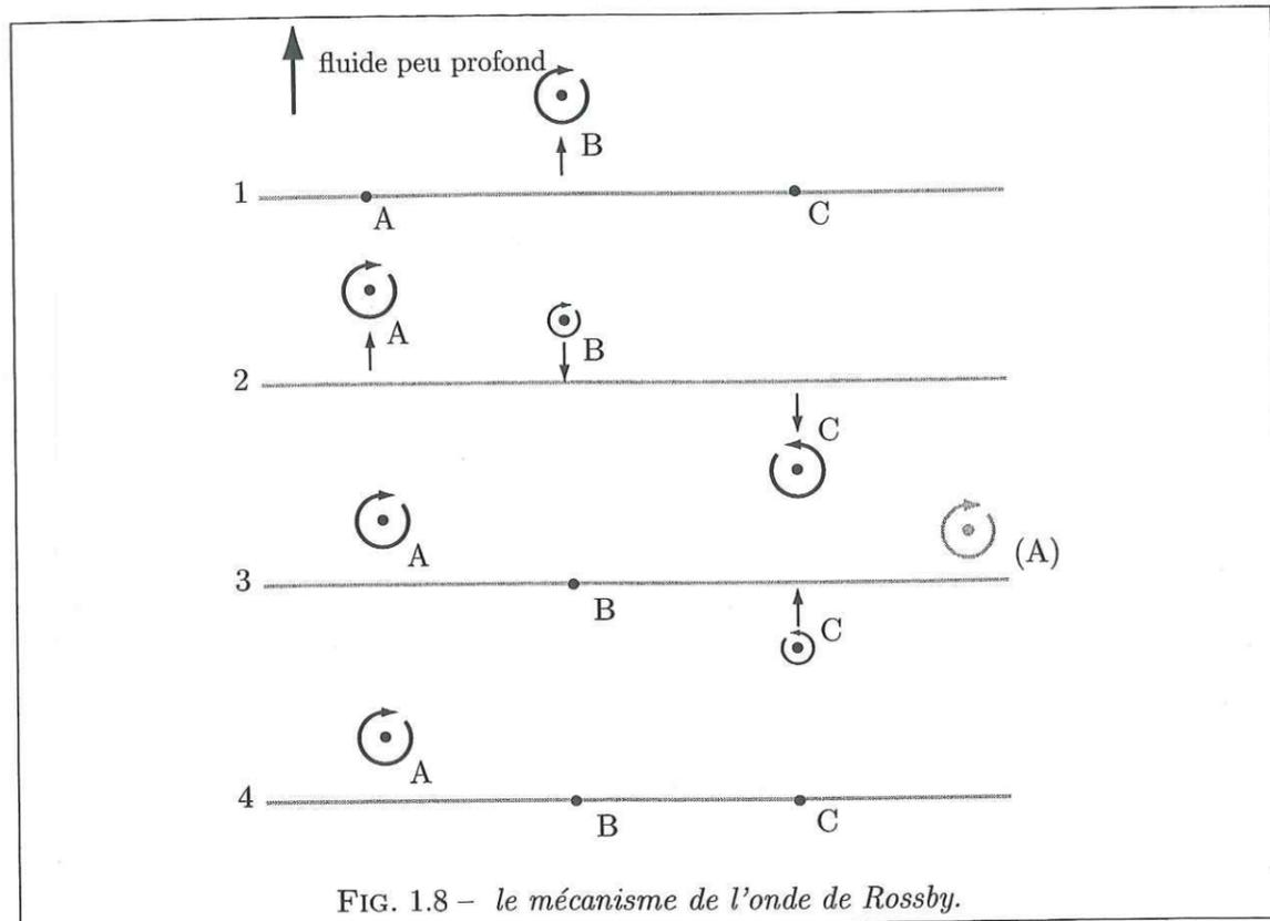
FIG. 1.8 – le mécanisme de l'onde de Rossby.
