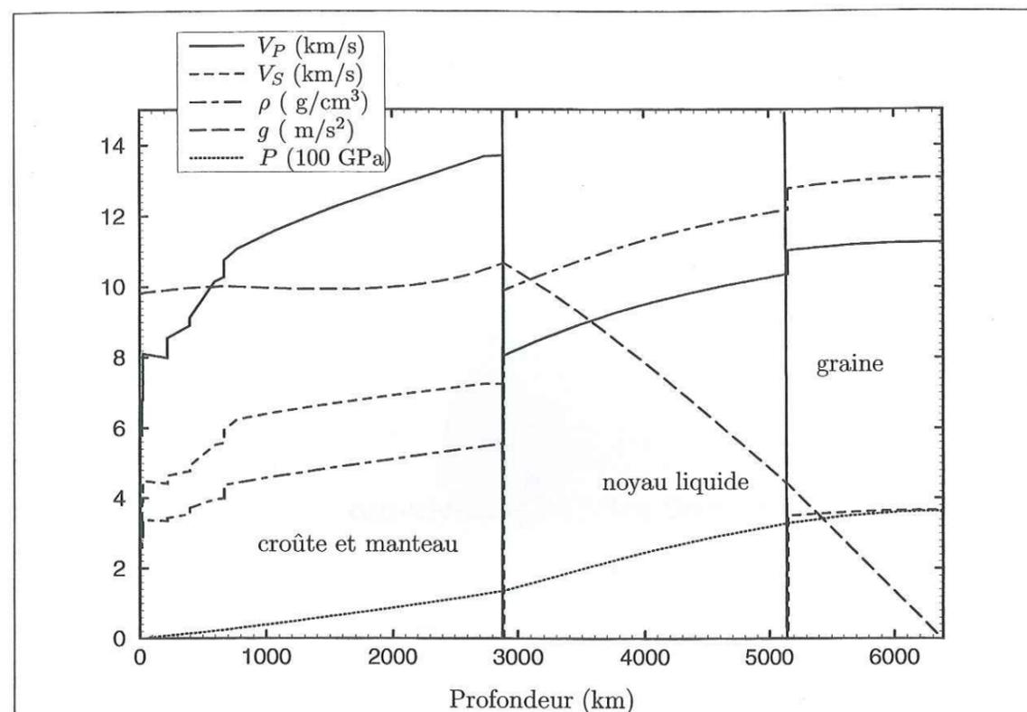
FIG. 2 – Modèle PREM (Dziewonski et Anderson, 1981).  $V_P$  est la vitesse des ondes de compression,  $V_S$  celle des ondes de cisaillement (qui ne se propagent pas dans les liquides),  $g$  la gravité et  $\rho$  la masse volumique.  $P$  est la pression hydrostatique déduite de ces observations, en centaines de gigapascals.
