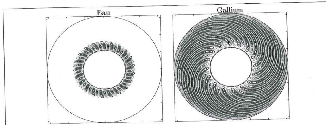
FIG. 3.8 – Tracés de vorticités pour les ondes de Rossby au seuil, en chauffage différentiel. A gauche, mode critique 21 pour  $P = 7$  (eau), dans la situation  $E = 9.74 \cdot 10^{-6}$ ; à droite: mode critique 16 pour  $P = 0.025$  (gallium), dans la situation  $E = 1.46 \cdot 10^{-6}$ .
