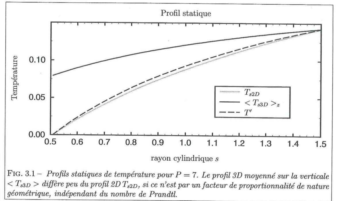
FIG. 3.1 – Profils statiques de température pour  $P = 7$ . Le profil 3D moyenné sur la verticale  $\langle T_{s3D} \rangle_z$  diffère peu du profil 2D  $T_{s2D}$ , si ce n'est par un facteur de proportionnalité de nature géométrique, indépendant du nombre de Prandtl.
