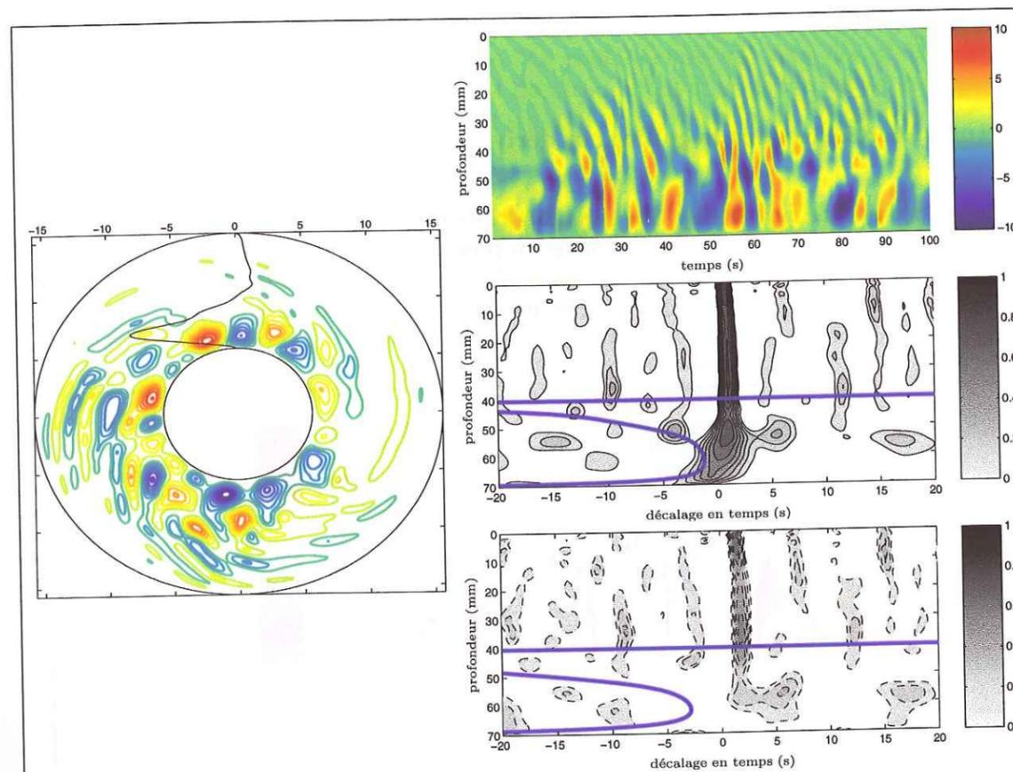
FIG. 3.37 -  $E = 1.46 \cdot 10^{-6}$ ,  $P = 0.025$ ,  $Ra = 1.5Ra_c$ . A gauche: fonction courant du modèle numérique. En haut à droite: profil synthétique de vitesse radiale. En bas à droite: cartes de corrélation entre synthétiques distants de 5 degrés (traits pleins), et dix degrés (traits pointillés). Le trait fort représente le temps que mettraient les structures à être advectées par le mouvement zonal.
