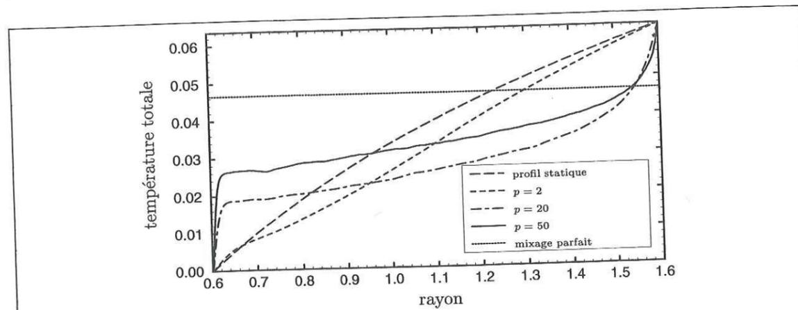
FIG. 3.18 -  $E = 9.7 \cdot 10^{-6}$ ,  $P = 7$ . Profils de la composante axisymétrique de la température en fonction du paramètre critique  $p$ . La ligne horizontale est la température de l'intérieur prévue par la théorie du mixage parfait.
