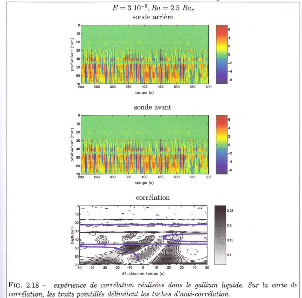
FIG. 2.18 – expérience de corrélation réalisées dans le gallium liquide. Sur la carte de corrélation, les traits pointillés délimitent les taches d'anti-corrélation.
