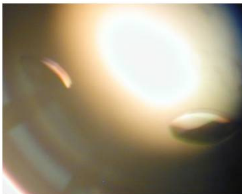
Figura 40. Cristais de PELa obtidos na presença de trimanose ( \alpha Man1-3( \alpha Man1-6)Man). Condições de cristalização (Hampton Screen II , condição 42): Tris 0,1 M pH 8,5, Sulfato de amônio 1,5 M, Glicerol 12% v/v.
