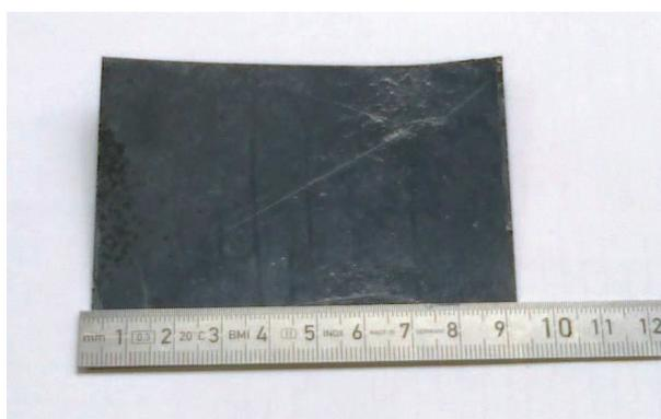
**Figure 67:** Photographie d'un substrat obtenu par enduction avec pompe à vide
