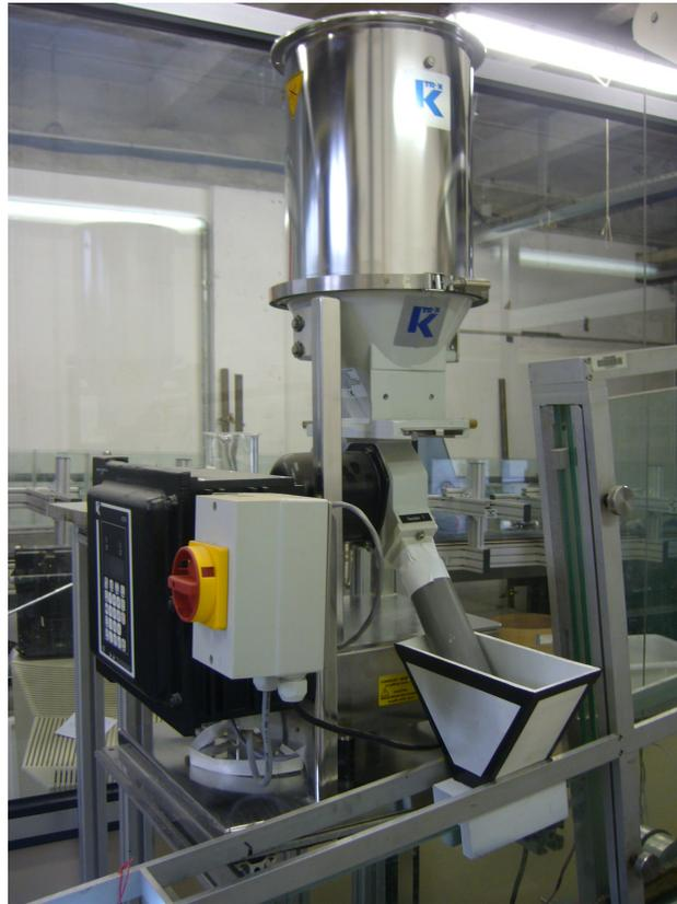
Fig. 2.4 – Photo du doseur pondéral BSP choisi pour injecter les billes de 4 mm.
