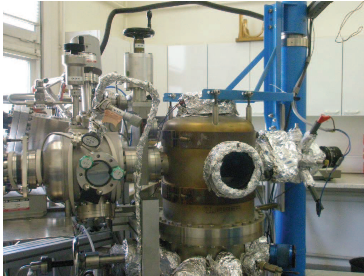
FIGURE 3.1 – Bâti d'évaporation ultra vide avec à gauche le sas et à droite la chambre de dépôt ultra vide
