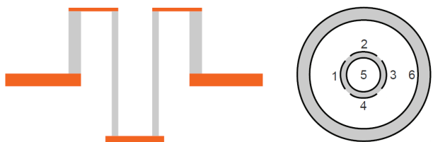
FIGURE 4.3 – Schéma en coupe et vue de dessous des tubes avec les électrodes à droite. Les tubes sont représentés en gris et les pièces de cuivre en orange. Les électrodes 1-3 et 2-4 sont utilisées pour balayer la pointe et les autres pour l'approcher ou l'éloigner de l'échantillon.
