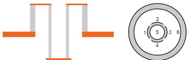
FIGURE 4.3 – Schéma en coupe et vue de dessous des tubes avec les électrodes à droite. Les tubes sont représentés en gris et les pièces de cuivre en orange. Les électrodes 1-3 et 2-4 sont utilisées pour balayer la pointe et les autres pour l'approcher ou l'éloigner de l'échantillon.
