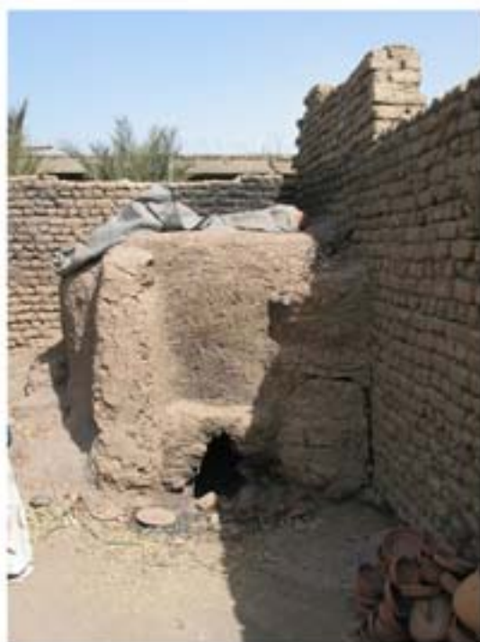
Fig. 4. Four à sole d'un atelier de Hagaza (Haute Egypte), photographié lors d'une étude en mai 2003
